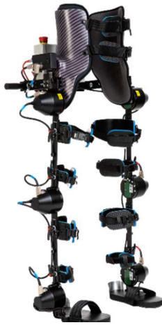
Figura 2. Exoesqueleto Exo-H3 (Technaid S.L., Madrid, España)
