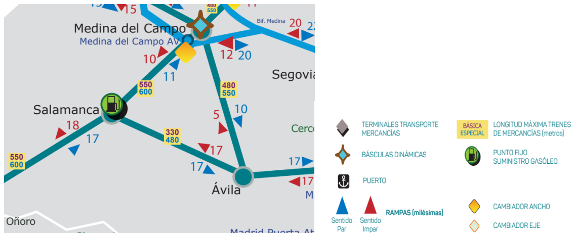
Ilustración 5. Principales Terminales de Transporte de Mercancías, Puntos fijos de Suministro de Gasoil, Longitud máxima de los Trenes de Mercancías, Básculas dinámicas, Rampas características en milésimas y Puertos de Interés General con Convenio de Conexión a la RFIG. Fuente: (ADIF 2023)
