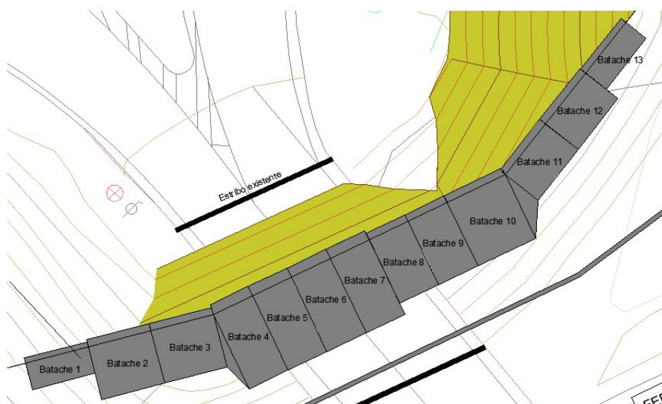
Ilustración 1. Croquis la estructura proyectada dividida en 13 bataches. Fuente: propia
