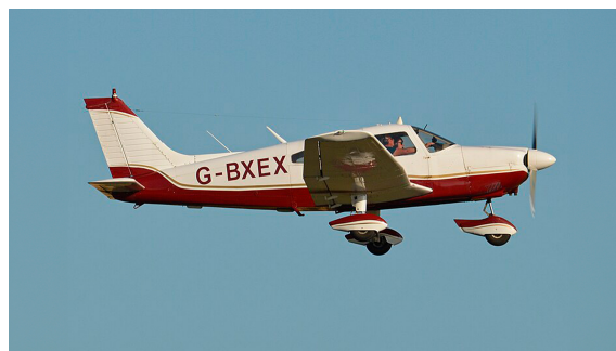
Figura 3.4 – Avión Piper PA28-181 [3]. Ala recta, sin flecha, perfil moderado o grueso y sin estrechamiento.
