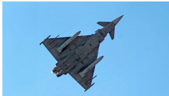
Figura 3.3 – Avión Eurofighter Typhoon [2]. Ala delta, con baja esbeltez, alto estrechamiento y perfil fino
