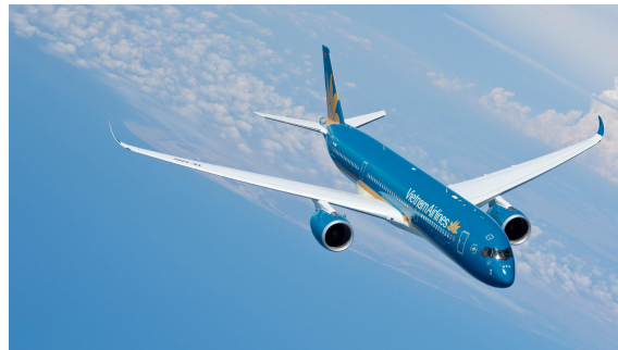
Figura 3.2 – Avión A350-900 de Vietnam Airlines [1]. Ala con flecha alta, diedro pequeño, estrechamiento moderado
