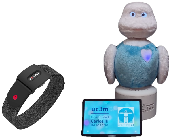
Figura 1: Elementos hardware utilizados en este trabajo. Izquierda: dispositivo Polar Verity Sense para la medida del pulso. Derecha: robot social mini.
