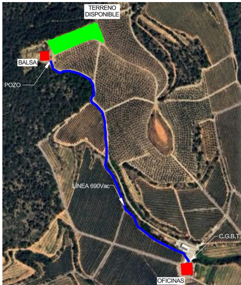
Ilustración 3 - Plano de la instalación eléctrica existente
