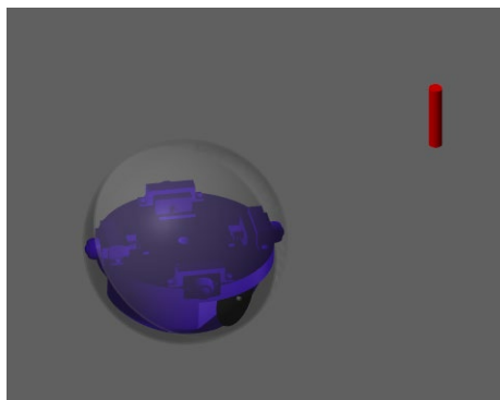
Figura 91. Captura de la visualización de la simulación del desplazamiento a un punto en Simscape Multibody.
