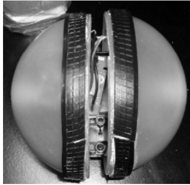
Figura 16. Esfera con mecanismo basado en dos hemisferios independientes [6].
