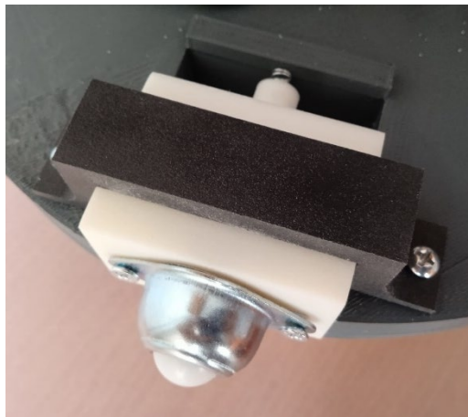
Figura 106. Detalle de la sujeción de la rueda esférica.
