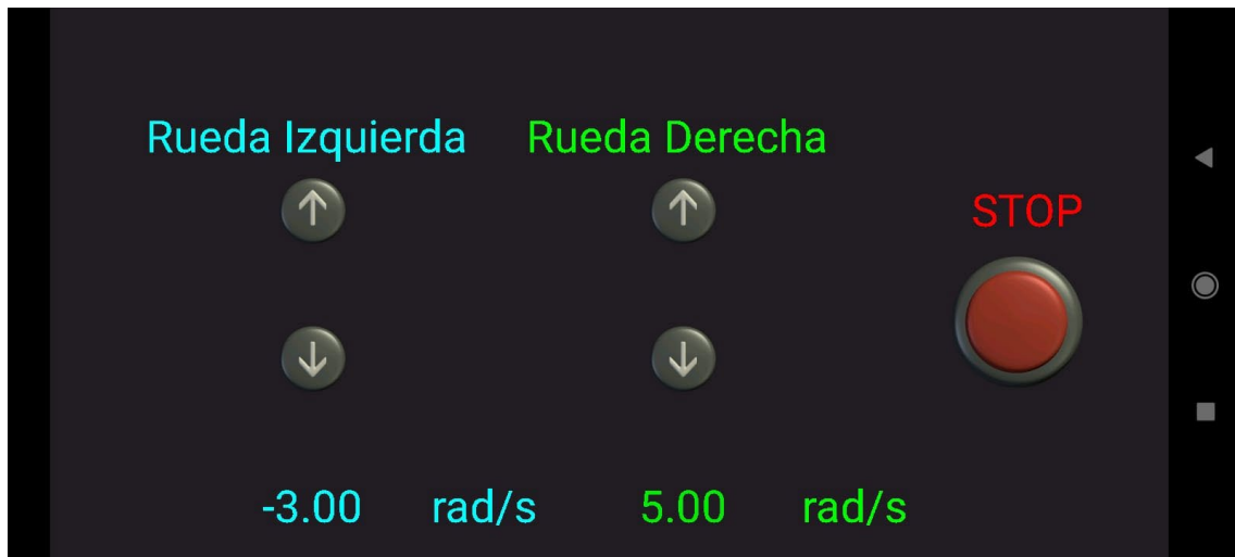
Figura 114. Interfaz de usuario de la aplicación de control remoto creada en Bluetooth Electronics .
