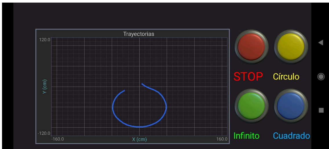
Figura 125. Seguimiento de la trayectoria circular en la aplicación Android.
