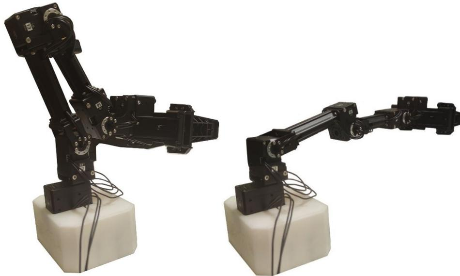
Figura 40 y 41: Brazo replegado previo al lanzamiento y desplegado una vez a lanzado la pelota.
