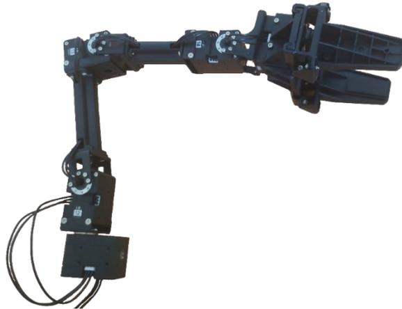
Figura 3: Robot OpenMANIPULATOR-X montado. (Fuente: Elaboración propia).
