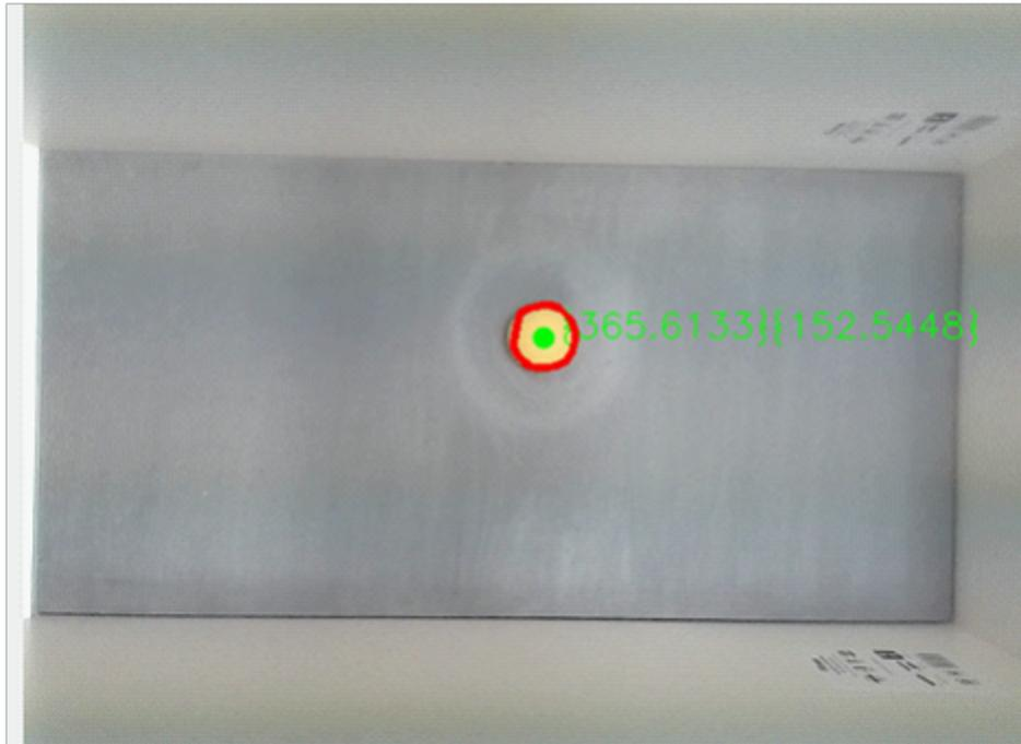
Figura 33: Detección de la pelota de frontón en el agujero con coordenadas reales. (Fuente: Elaboración propia).
