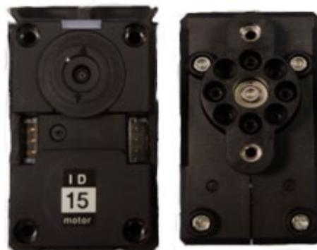
Figura 4 y 5: Motor XM430-W350-T de la pinza. (Fuente: Elaboración propia).
