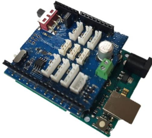
Figura 6: Dynamixel Shield y Arduino UNO. (Fuente: e-manual de ROBOTIS [9]).
