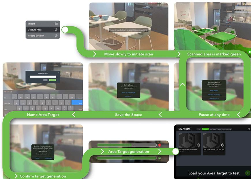
Figura 16: Ciclo de vida de la aplicación Vuforia Area Target Creator.
