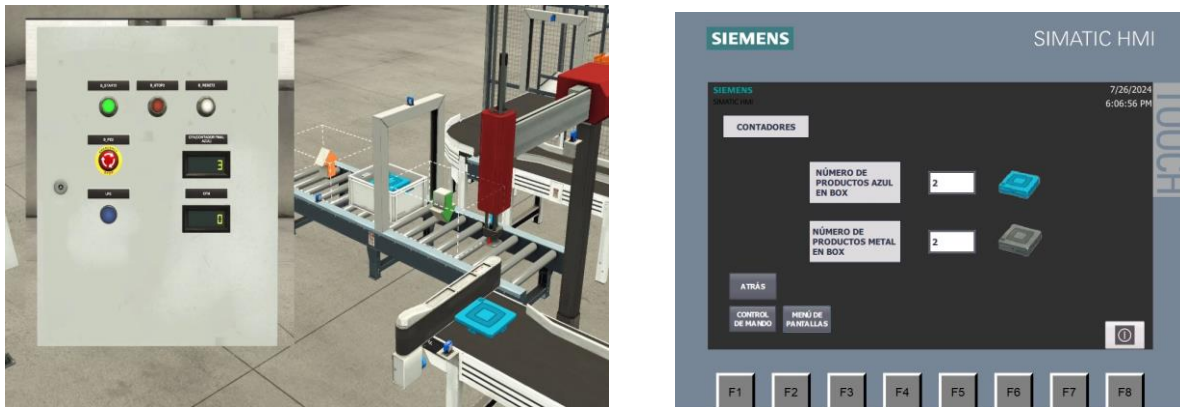
Figura 48. Secuencia de desplazamiento de cajas con producto ensamblado y pantalla de contadores en HMI.
