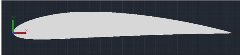
Figura 10: NACA 4412 en el entorno de *AutoCad*
