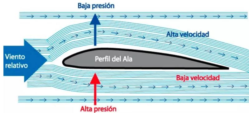
Figura 2: Principio de Bernoulli aplicado a un perfil aerodinámico [1]
