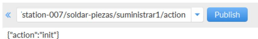
Figura 5.5: Ilustración de como se vería un mensaje de ejemplo de action enviado a través de MQTTfx
