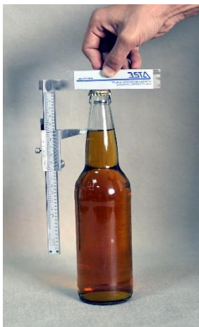
Ilustración 10. Calibre nivel de llenado. Extraído de www.at2e.mx
