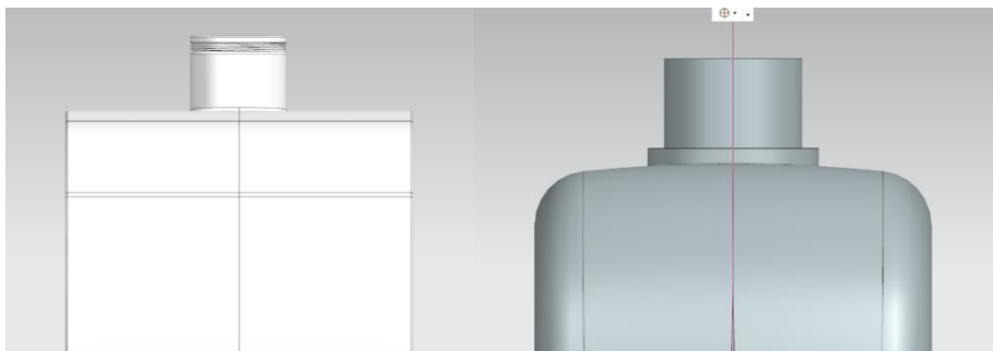
Ilustración 96. Ángulo de desmoldeo. Elaboración propia.
