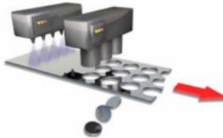
Ilustración 63. Troquelado del aluminio. Extraído de latasdebebidas.org
