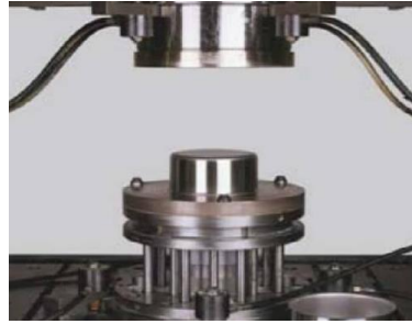
Ilustración 64. Proceso de embutición profunda. Extraído de www.ampcometal.com
