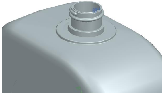
Ilustración 101. Anillo centrador cuello envase. Elaboración propia.
