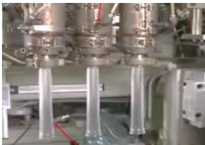
Ilustración 36. Extrusión del parison. Extraída de RNB cosméticos.
