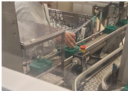
Ilustración 72. Colocación manual del tapón. Extraído de RNB cosméticos.
