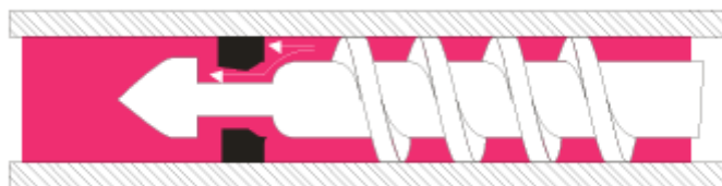
Ilustración 45. Cilindro de plastificación. Obtenido de rua.ua.es.
