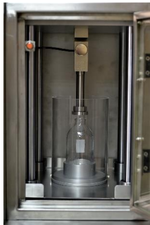
Ilustración 102. Instrumento medición resistencia a la carga vertical. Obtenido de at2e.mx
