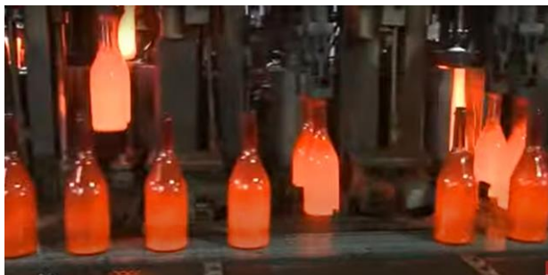
Ilustración 59. Recocido envase. Obtenido de WiseGen.
