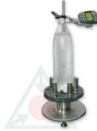
Ilustración 103. Probador presión interna. Obtenido de atrya.com.mx
