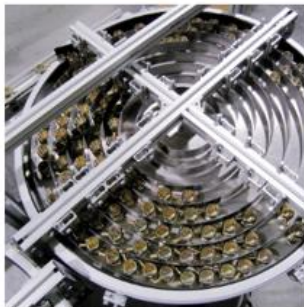
Mesa giratoria como estación de almacenamiento o de almacenamiento transitorio con guía de acero inoxidable en forma de espiral
