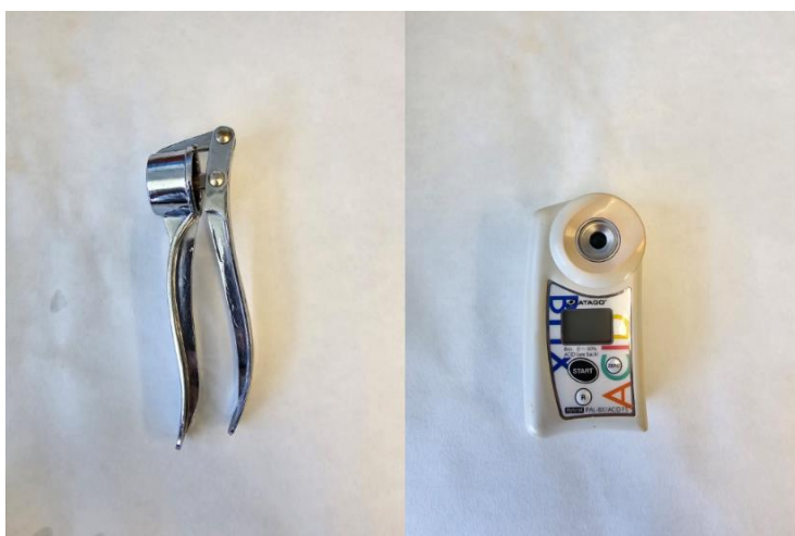
Figura 16. Machacador de ajos y refractómetro de mano, se utilizaron para el análisis de los sólidos solubles totales (SST). Fuente: Elaboración propia.
