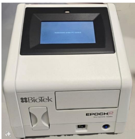
Figura 15. Espectrofotómetro con el que se analizaron el contenido de carotenoides en las variedades tradicionales. Fuente: Elaboración propia, procesada con IA.
