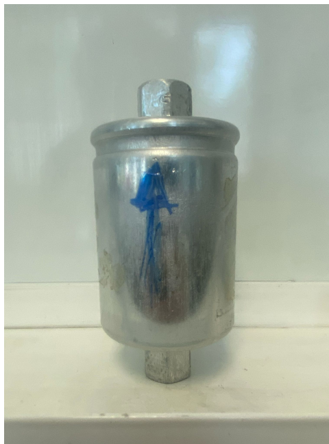
Figura 3.16. Filtro de combustible
