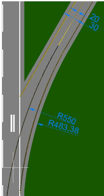
Ilustración 45: Dimensiones de la calle de salida rápida [Elaboración propia]
