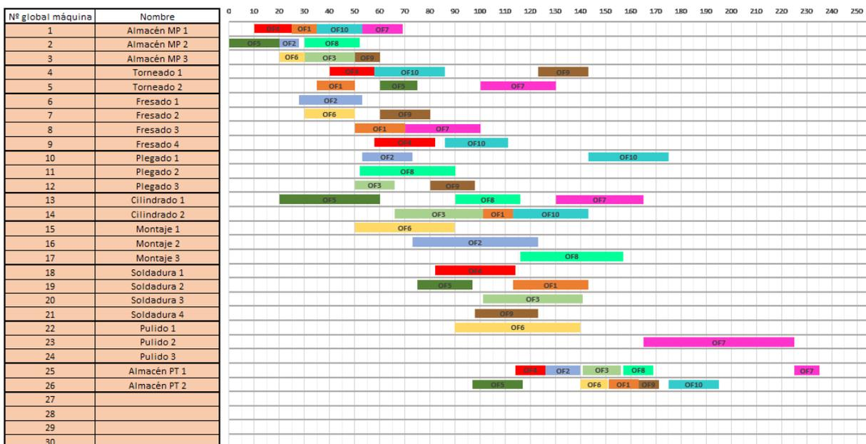
Figura 43. Diagrama de Gantt de la secuencia de operaciones con la regla EDD.
