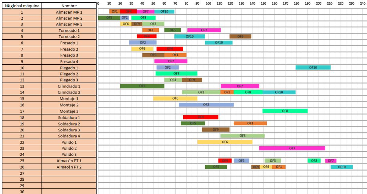
Figura 42. Diagrama de Gantt de la secuencia de operaciones con la regla SOT.
