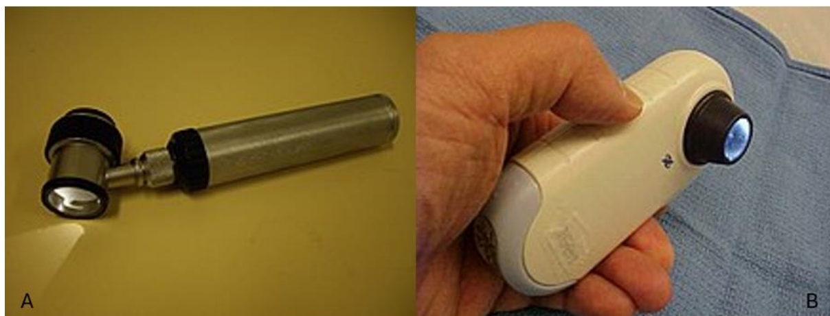
Figura 1. La figura 2A muestra un dermatoscopio con luz convencional. La figura 2B muestra un dermatoscopio con luz polarizada. Fuente: (Dermatoscopia - Wikipedia, la enciclopedia libre, s. f.)
