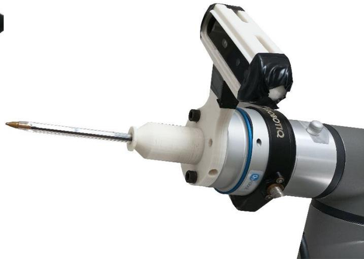
Fig 14: Soporte colocado y montado en el robot
