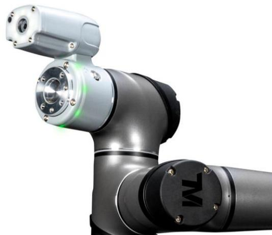
Fig 4: Cámara integrada en el brazo
