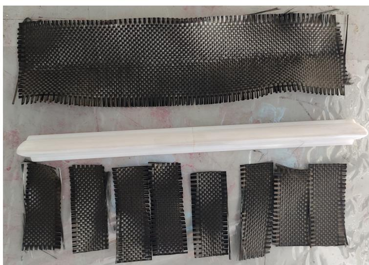
**Figura 8.2.3:** Capas de fibra de carbono junto al molde de una de las piezas
