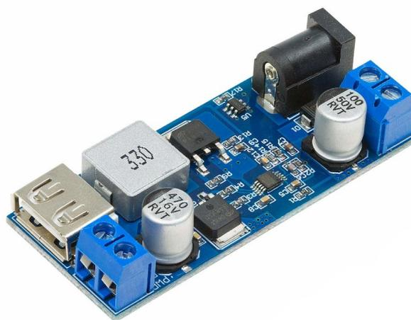
**Figura C.3.6:** Convertidor de voltaje
