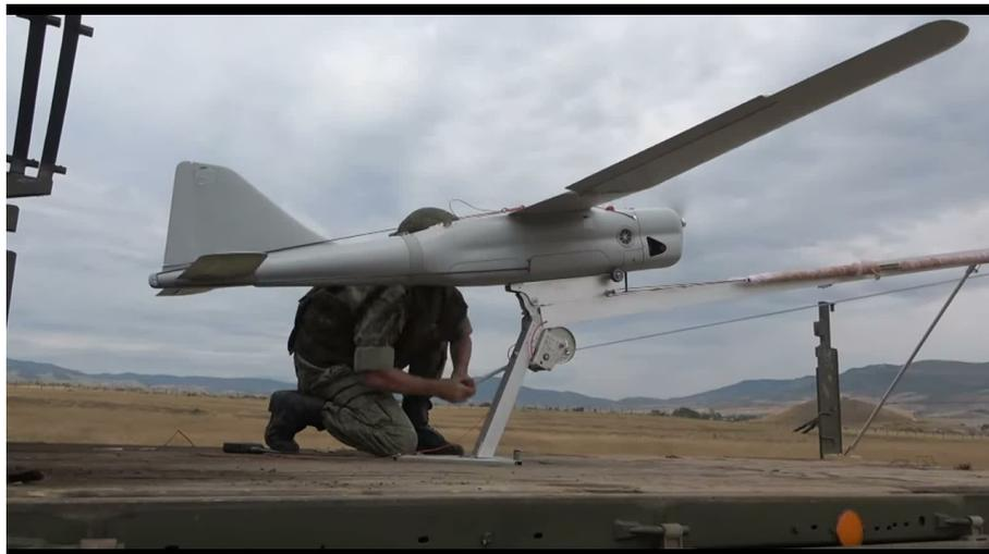
*Figura 2.3.1: Aeronave Orlan-10 sobre el sistema de catapulta para el lanzamiento [23]*
