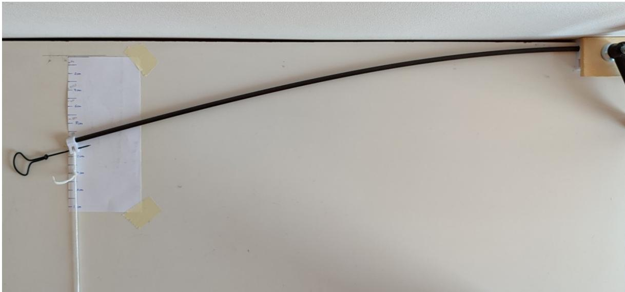
**Figura 4.3.2:** Deformación provocada por una carga de 10 N
