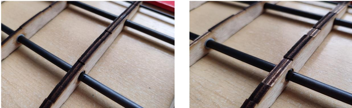
*Figura 8.5.4: Parte de las costillas alares antes y después del lijado*
