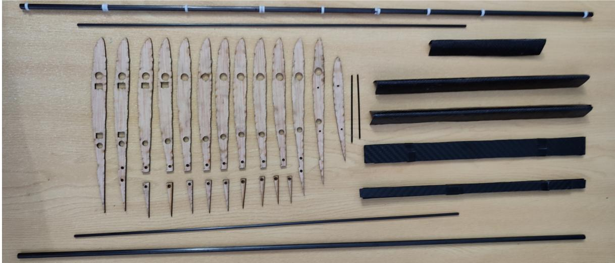
*Figura 8.2.6: Recopilatorio de las piezas que forman la estructura alar*
