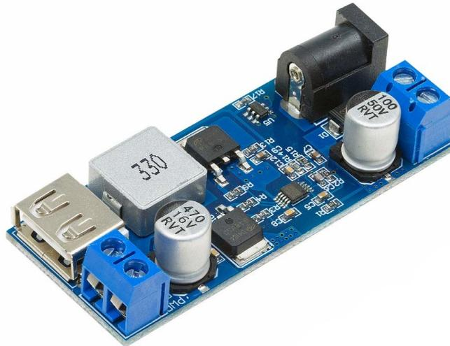
*Figura 5.6.1: Módulo conversor de 12V a 5V*
