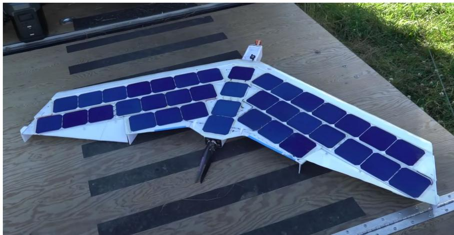
*Figura 2.3.2: Ala volante solar fabricada con poliestireno expandido [24]*
