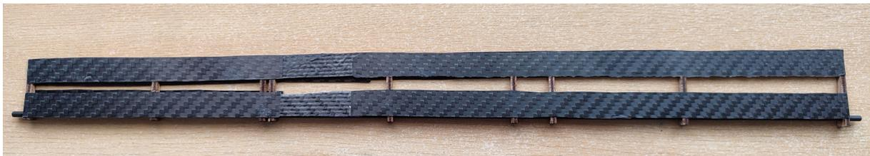
*Figura 8.5.2: Estructura del alerón tras añadir los paneles de material compuesto*
