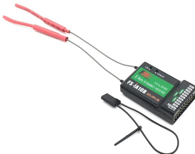
**Figura C.3.8:** Controladora fs-ia10b de 2.4GHz
