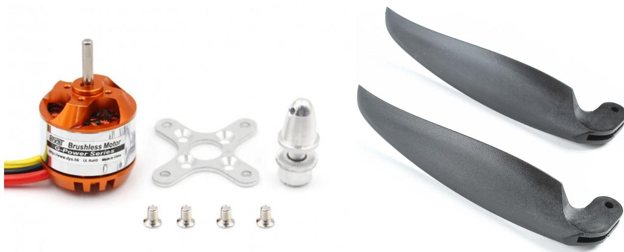
**Figura C.3.9:** Conjunto motor-hélice
