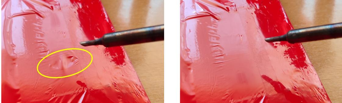
*Figura 8.5.7: Ejemplo de irregularidad eliminada con ayuda del soldador*
