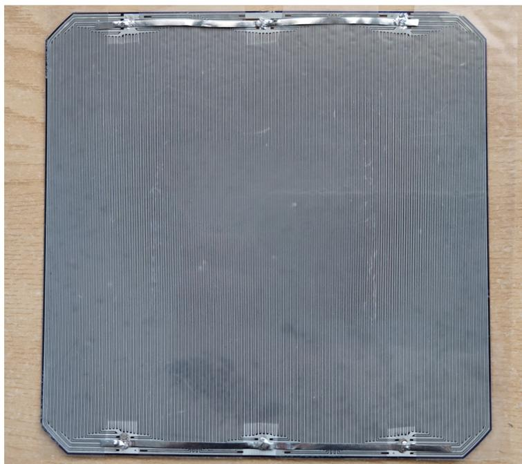
*Figura 8.3.3: Panel solar con las conexiones realizadas*
