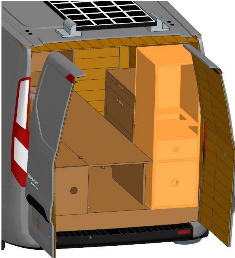
Imagen 69. Montaje estantería lateral
