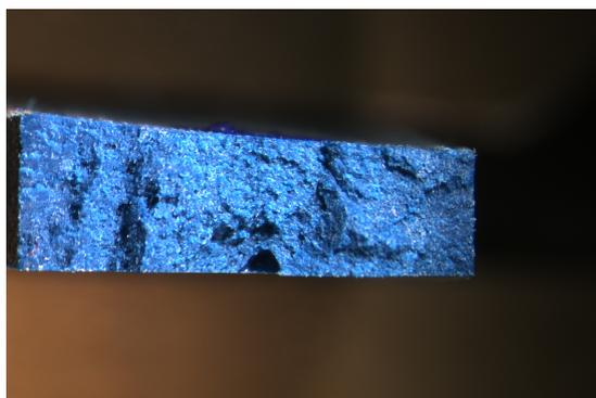
Figura 106: Imagen microscopio x1 de la probeta de ensayo de tracción P6
