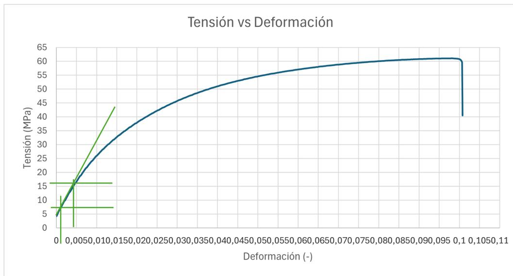
Figura 52: Curva tensión-deformación probeta de tracción en dirección longitudinal 3
