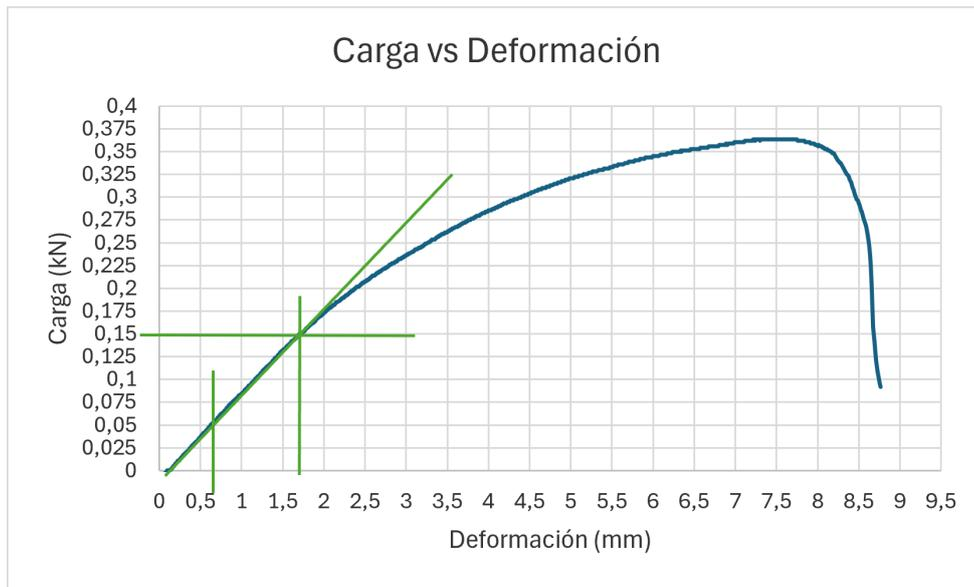
Figura 86: Curva carga-deformación probeta de flexión de la pieza inyectada 7
