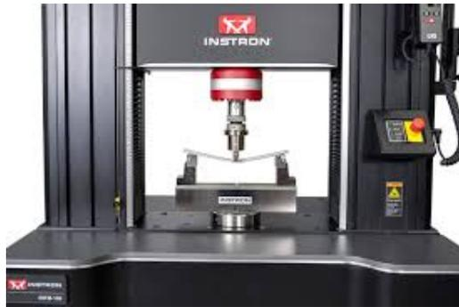
Figura 14: Maquina de ensayo de flexión
