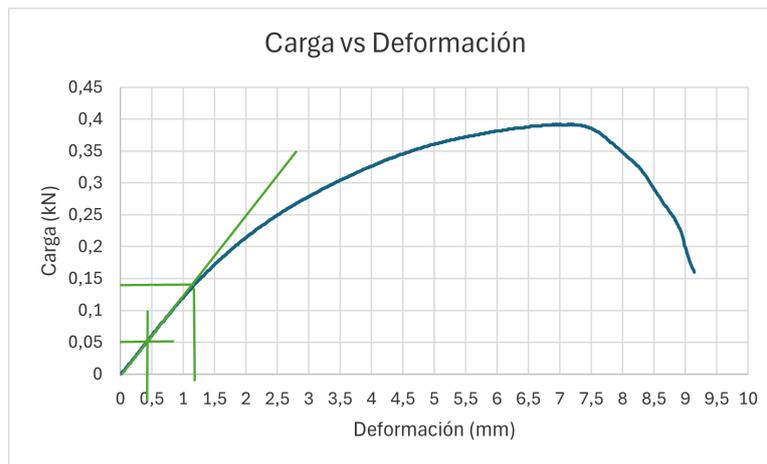
Figura 17: Curva carga-deformación de flexión de la probeta en dirección longitudinal LT1
