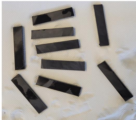
Figura 16: Probetas para ensayos de flexión y/o impacto dirección longitudinal
