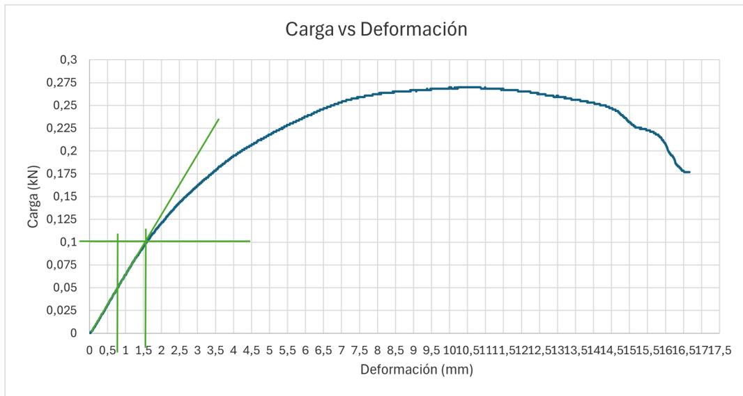
Figura 90: Curva carga-deformación probeta de flexión de la pieza inyectada 11
