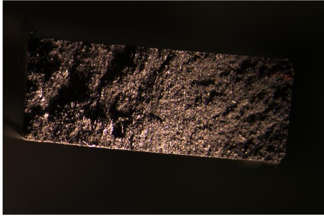
Figura 10: Imagen microscopio x1 de la probeta de ensayo de tracción TLT3
