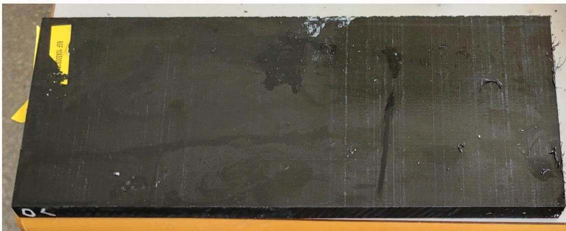
Figura 1: Placa de poliamida reforzada con fibra de vidrio extruida
