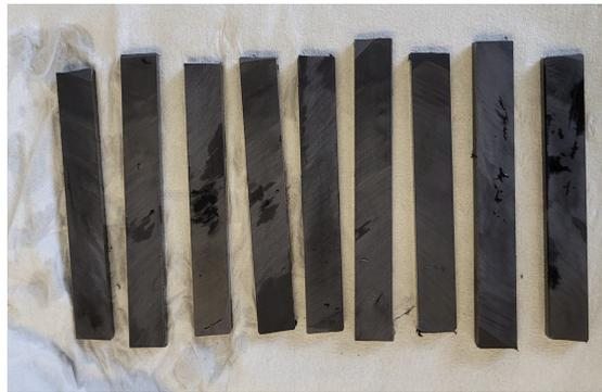
Figura 15: Probetas para ensayos de flexión y/o impacto dirección transversal
