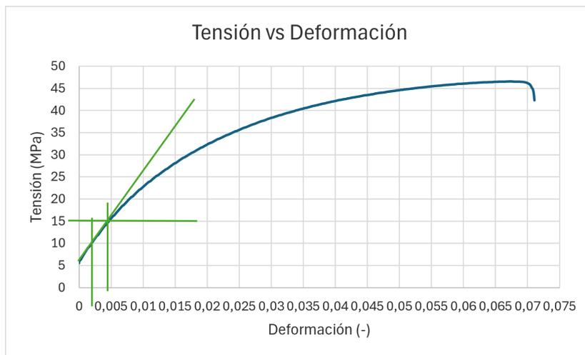
Figura 54: Curva tensión-deformación probeta de tracción en dirección transversal 2
