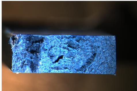
Figura 33: Imagen microscopio x1 de la probeta de ensayo de Impacto P10
