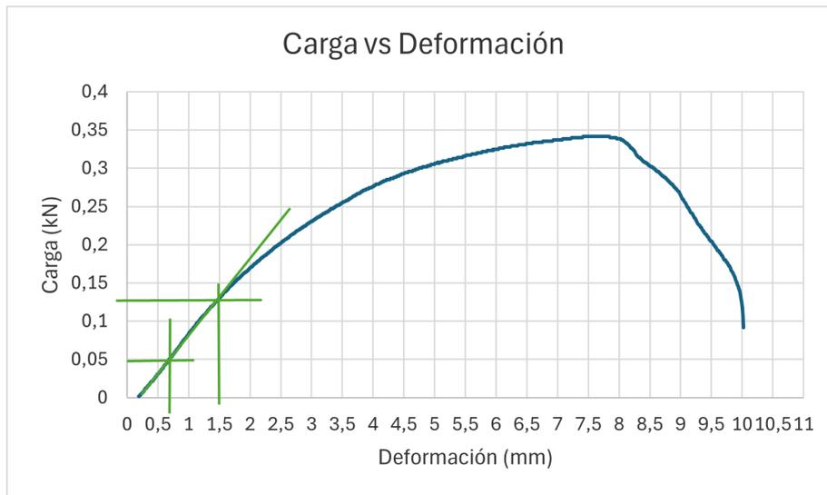
Figura 70: Curva carga-deformación probeta de flexión en dirección longitudinal LT2
