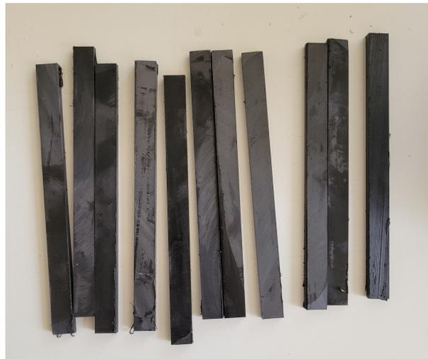
Figura 6: Probetas de ensayo de tracción de la placa extruida
