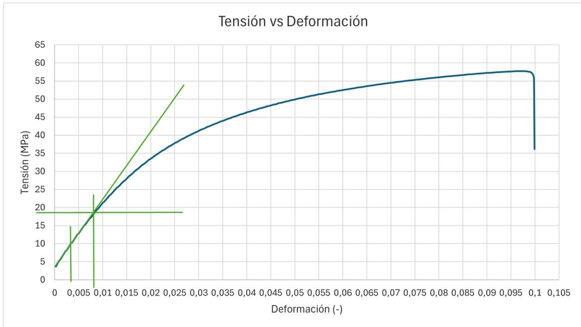
Figura 56: Curva tensión-deformación probeta de tracción de la pieza inyectada 1
