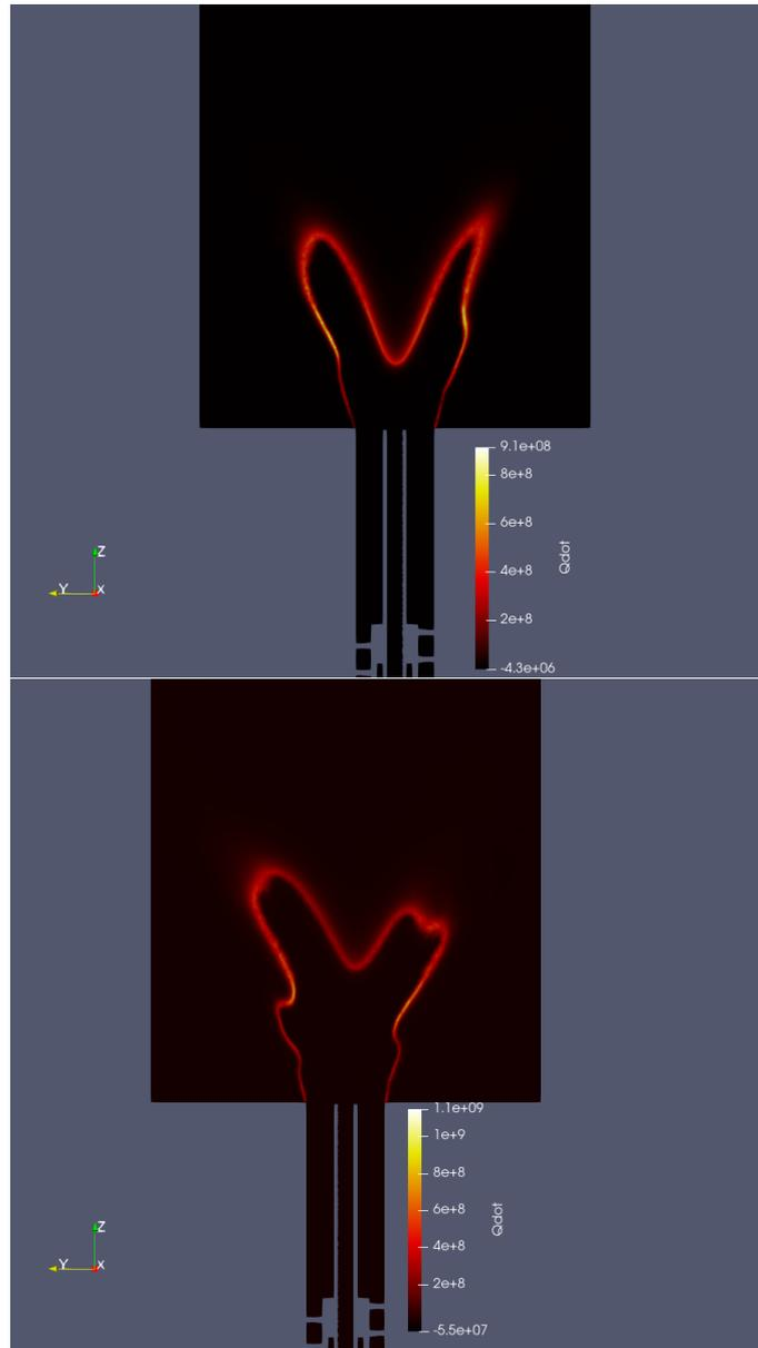
Figura 23: Calor liberado en la solución con  $AR = 10\%$  Arriba (a) y  $AR = 15\%$  Abajo (b) [ $W/m^3$ ].
