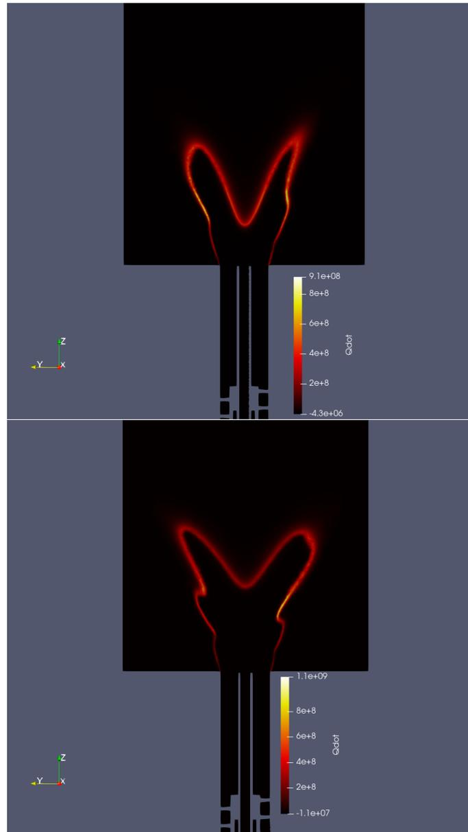
Figura 12: Comparación del valor de  $\dot{Q}$ : Arriba (a) Esquema de segundo orden con  $\gamma = 0,5$ , Abajo (b) Esquema de primer orden *upwind*.
