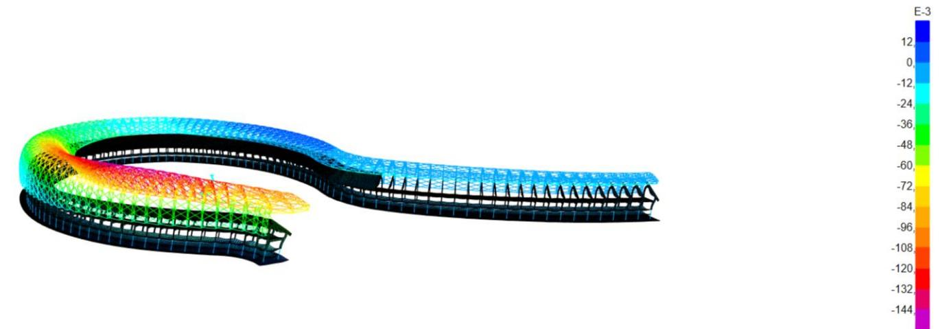
Ilustración 54. Deformada con respecto al eje Y en la combinación más desfavorable (ELSvy-). Escala en mm.
