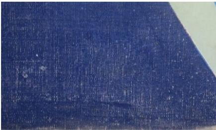
Figura 29. Detalle de zona con abrasión y suciedad superficial.
