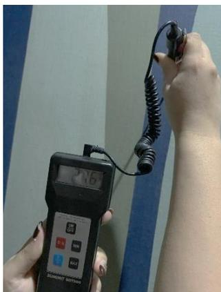
Figura 46. Fotografía de medición mediante sonda de contacto.
