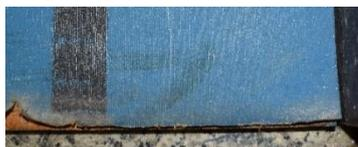
Figura 34, 35 y 36 Detalle del antes, durante y después de la cata de limpieza con la esponja Wishab<sup>®</sup> blanda.
