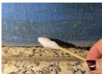
Figura 43. Prueba de sensibilidad con hisopo y agua destilada.
