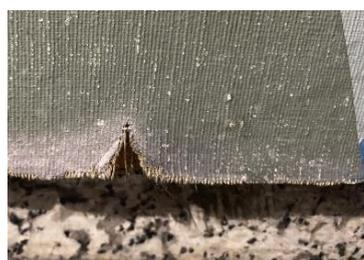
Figura 39 y 40. Detalle del antes y después de la cata de limpieza con la esponja de melamina.
