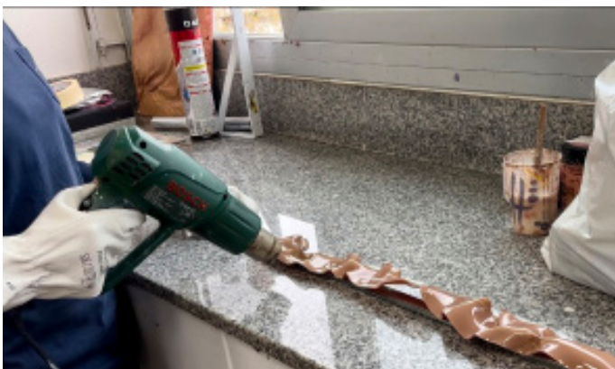
Fig. 28: Proceso del modelado de las planchas de poliestireno con pistola de calor en el taller, 2024.
