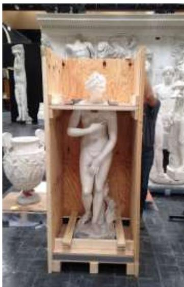
Figura 23. Ejemplo de caja de madera para transporte de esculturas. Carpintería Casmar.
