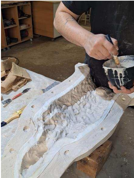
Fig. 80. Realización del positivo en escayola.
