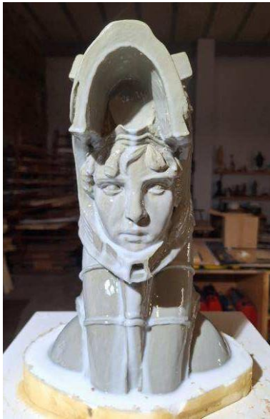
Fig. 86. Primera capa de silicona.
