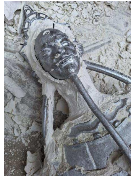
Fig. 40. Rotura de la cáscara cerámica.
