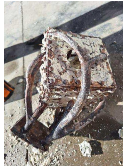
Fig. 53. Rotura de la cáscara cerámica.
