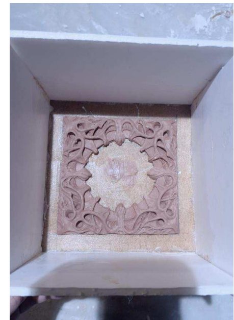
Fig. 46. Caja de cartón pluma para la realización del molde en bloque.
