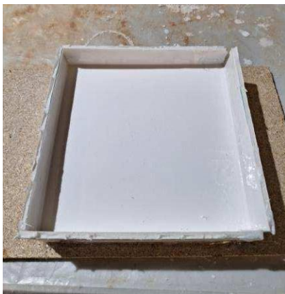
Fig. 48. Molde en bloque de silicona.
