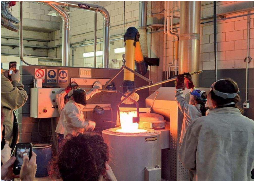
Fig. 39. Alumnos, técnicos y docentes extrayendo el crisol del horno.
