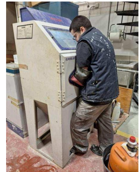
Fig. 54. Retirando el resto de cáscara con el chorro de arena.
