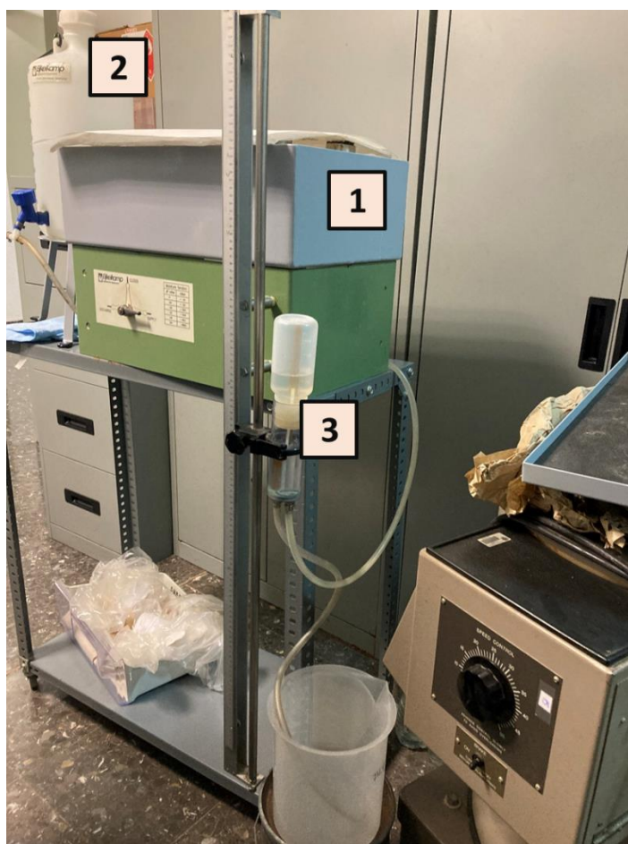
Figura 16. Montaje experimental de la mesa de arena (Laboratorio de Edafología, Departamento de Química).
