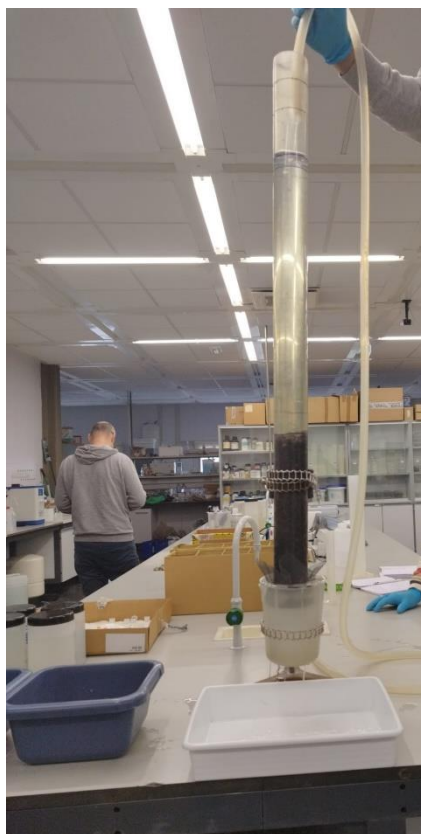
Figura 20. Montaje experimental para la determinación de la conductividad hidráulica saturada.
