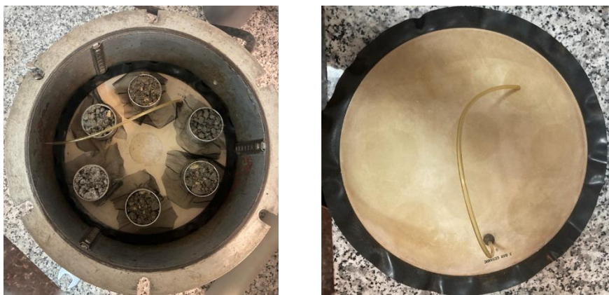
Figura 18. Muestras dentro de la olla de presión y plato cerámico sobre el que se colocan las muestras.
