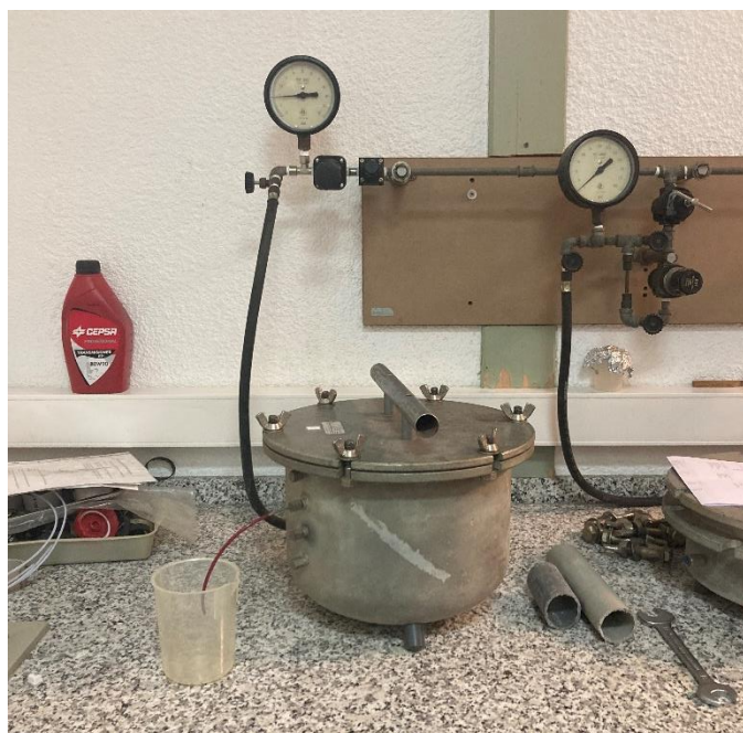
Figura 17. Dispositivo experimental de la cámara de presión (Laboratorio de Edafología, Departamento de Química).
