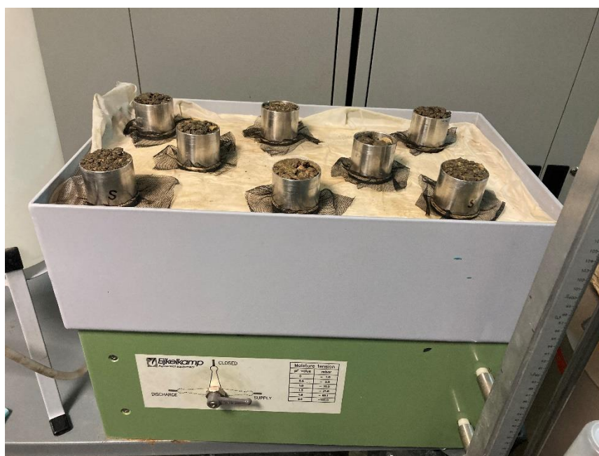
Figura 19. Muestras preparadas para los ensayos de succión en la caja de arena.
