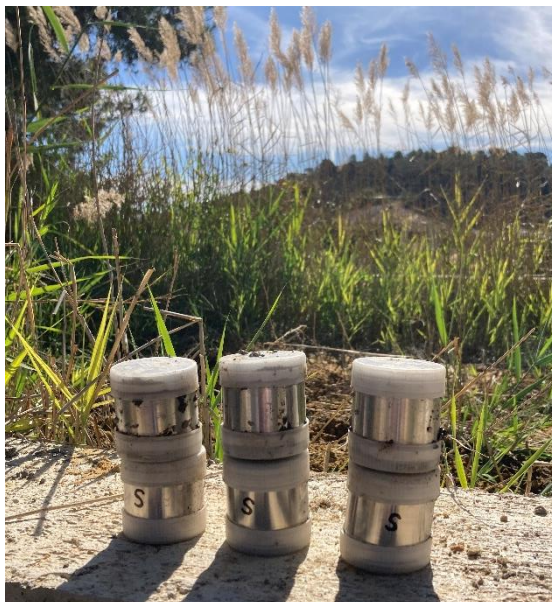
Figura 21. Muestras de sustrato inalterado tomadas in situ del humedal.
