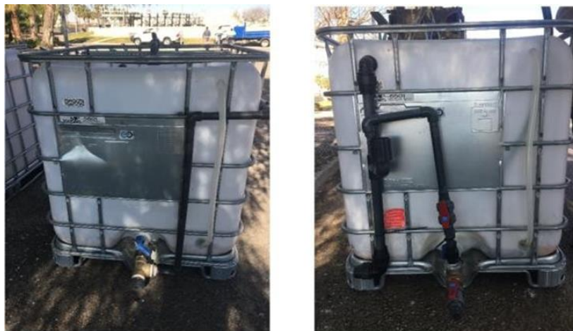
Figura 2. Plantas piloto de humedal artificial, a la izquierda en funcionamiento continuo y a la derecha por cargas (Martínez, 2019).
