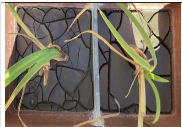
Día 38: Deshidratación de lodos en la superficie, H-1 (izquierda) y H-2 (derecha).
