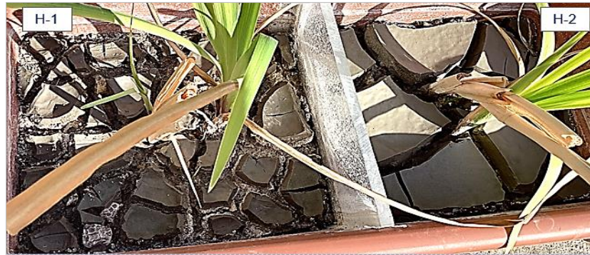
Figura 27. Deshidratación del lodo en H-1 y H-2
