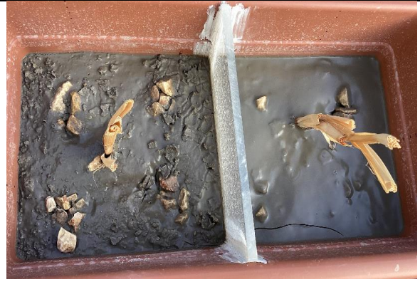
Día 19: Formación de grieta en H-2. eneas marchitas.
