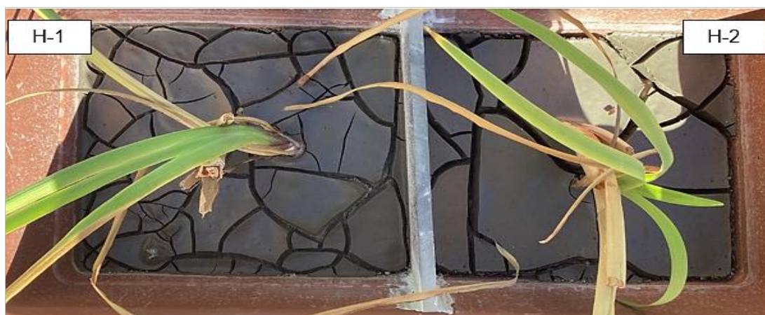
Figura 22. Formación de grietas por deshidratación del lodo en H-1 y H-2.
