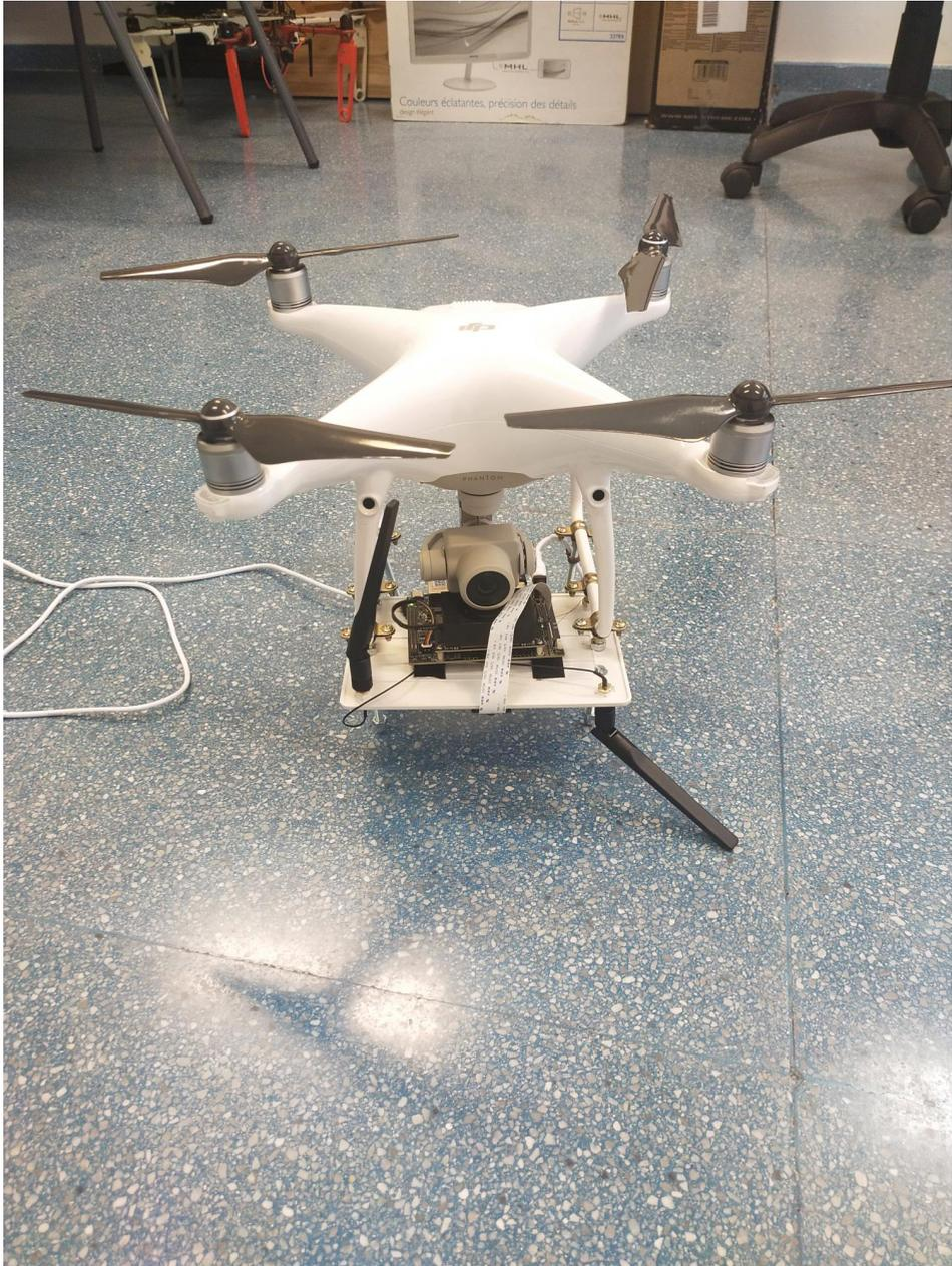
**Figura 4.15:** Montaje final del reComputer J3011 en el dron Phantom 4 Advanced+ [Elaboración Propia].
