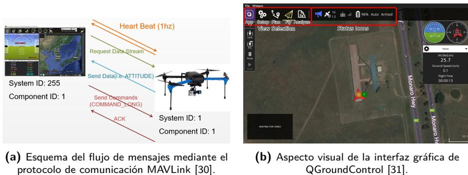
Figura 2.6: Proyecto Rosetta Drone. MAVLink y QGroundControl.
