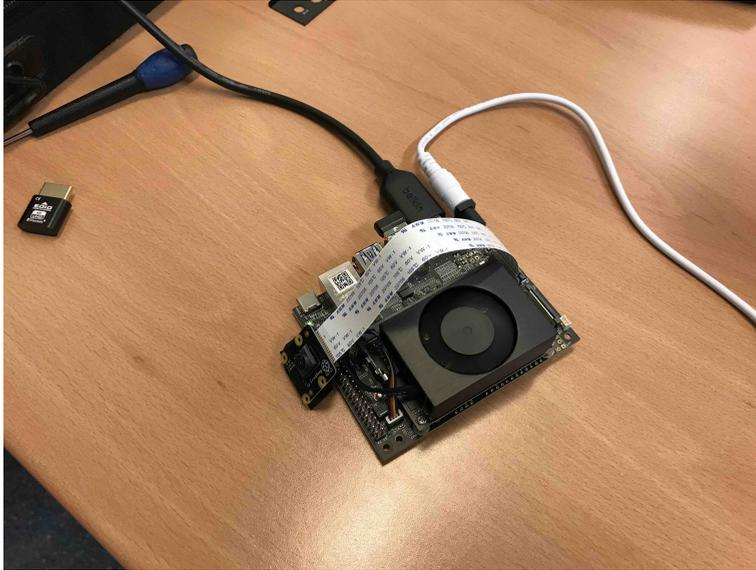
**Figura 4.4:** Conexión de la cámara Raspberry Pi NoIR Camera V2 al reComputer J3011 [Elaboración Propia].
