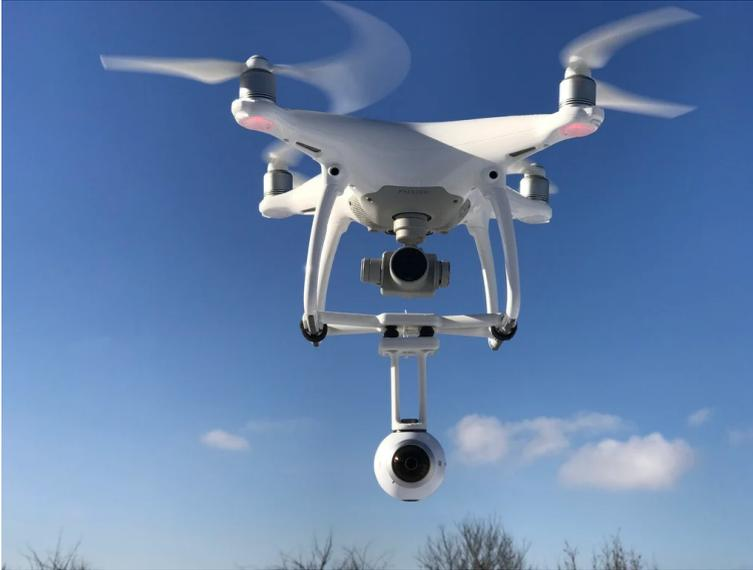
**Figura 4.11:** Soporte para cámara 360 para DJI Phantom 4 y Phantom 4 Pro [81].
