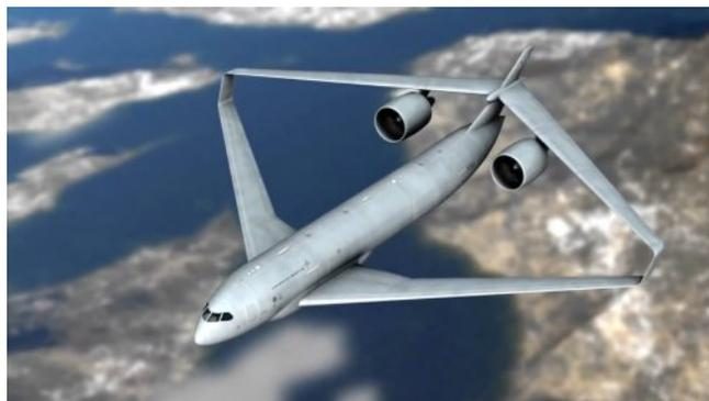
Figura 1.1.8: Diseño *joined-wing* para el estudio.
