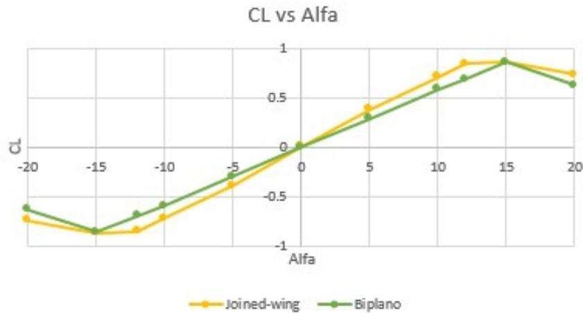
Figura 4.3.1: Gráfico CL vs ángulo de ataque *joined-wing* y biplano.
