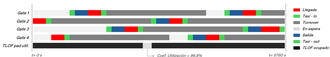
Figura 10.2: Proceso de operación de un vertipuerto.
