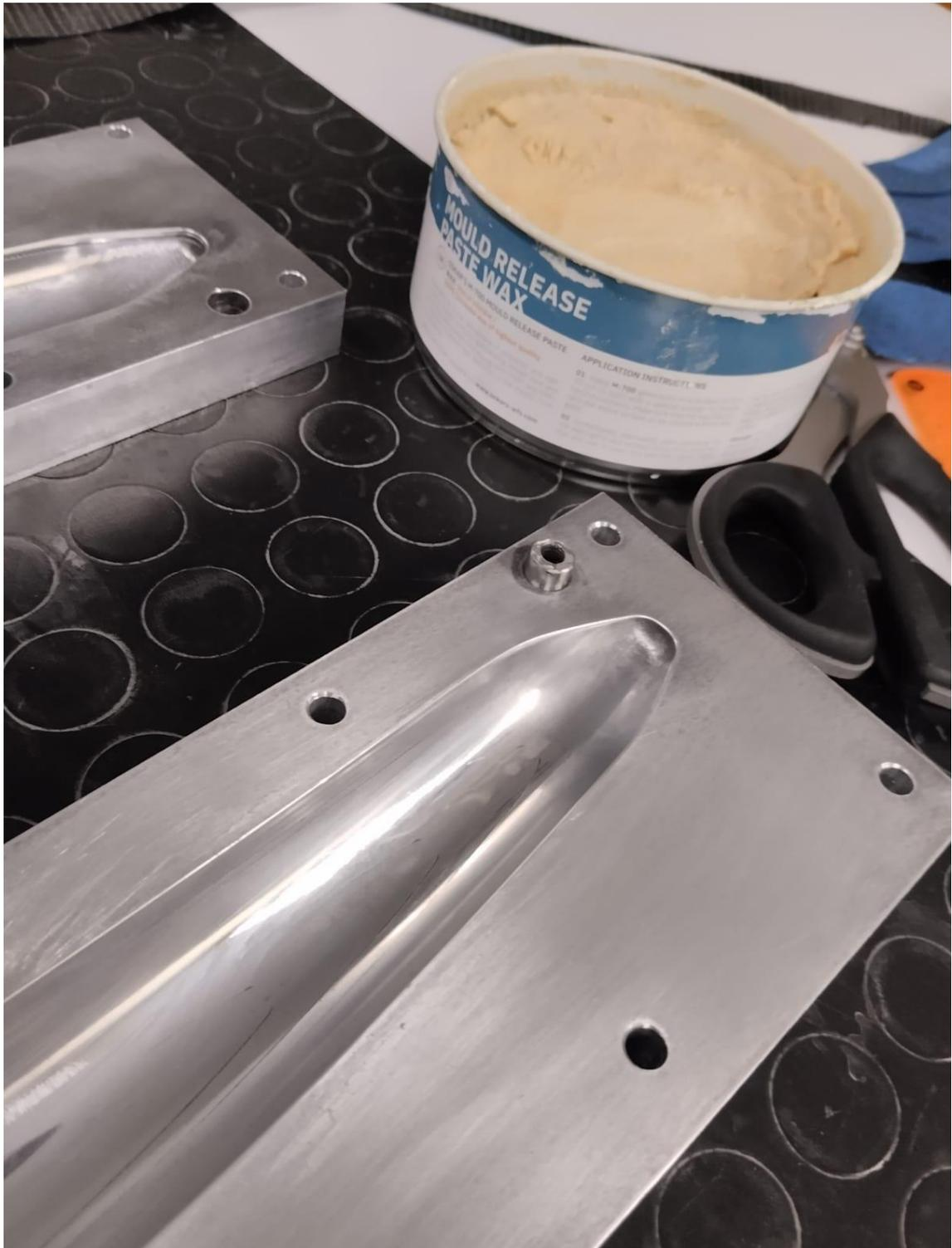
Figura 49: aplicación de desmoldeante
