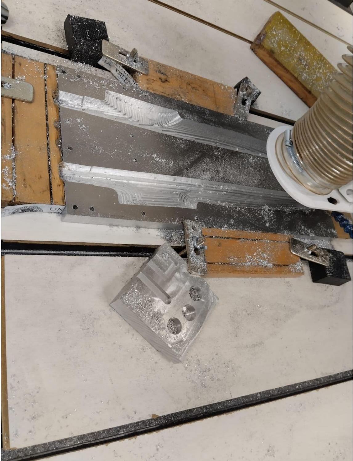
Figura 48: mecanizado de los moldes con CNC.
