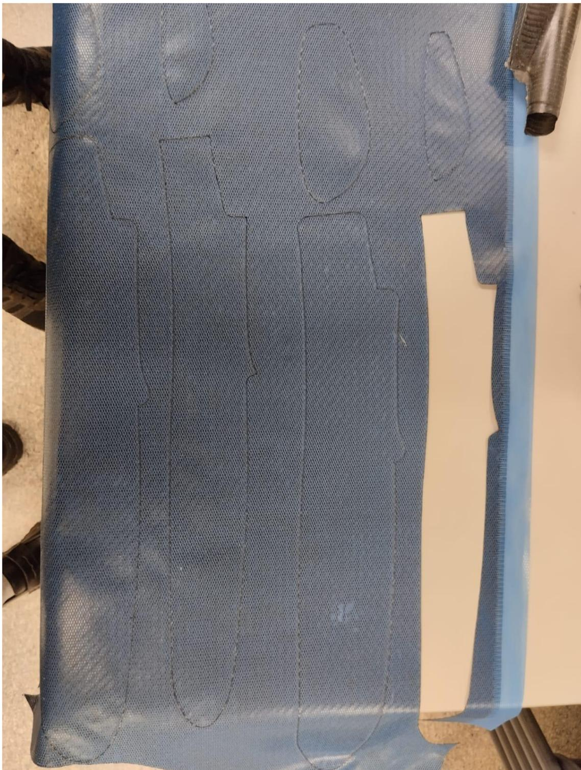
Figura 50: preparación de plantillas
