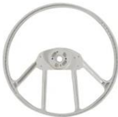
Ilustración 22 Estructura interna de magnesio
