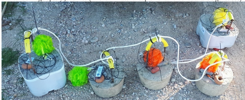
Figura 3.5: Instalación fondeada en las cercanías de la desembocadura de la gola de Perellonet. Se aprecian 5 lastres de hormigón unidos por una línea guía. Cada lastre está equipado con un colector del mismo tipo que los empleados en la campaña Estuarina 1 , con la única diferencia de que a mitad de la línea de recuperación se ha añadido un flotador para facilitar su localización en campo.
