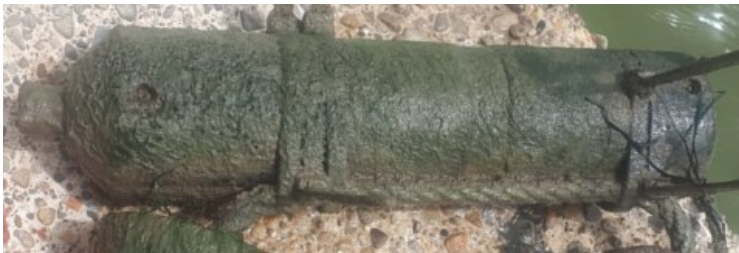
Figura 3.11: Hidrófono “Gola” tras 15 días instalado. Se aprecia una abundante bioincrustación compuesta mayoritariamente por algas filamentosas.
