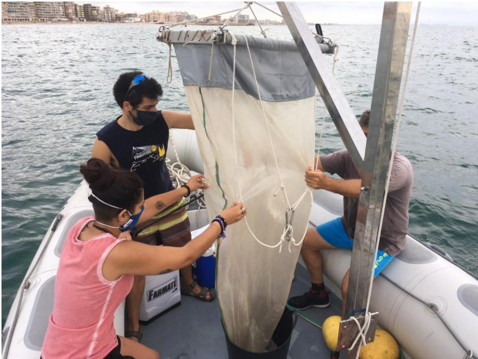
Figura 3.2: Proceso de limpieza de la red manta a bordo de la embarcación empleada para realizar los arrastres durante la campaña Costeru 1 .
