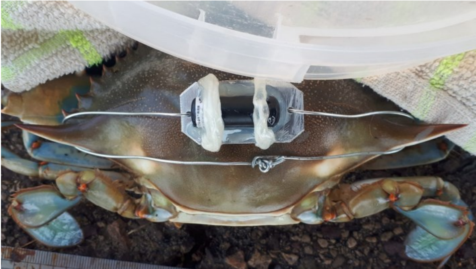
Figura 3.9: Ejemplar marcado son emisor acústico para su seguimiento. Sobre la placa el emisor va pegado mediante una resina epoxy, y posteriormente sujeto con dos vueltas de hilo de remendar redes envuelto en silicona para garantizar su correcta sujeción.
