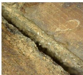
**Figura 74.** Detalle de la separación del nudo respecto al soporte con microscopio USB.
