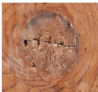
**Figura 73.** Detalle de un nudo agrietado del soporte.
