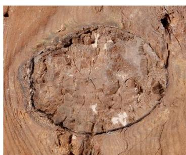
**Figura 72.** Detalle un nudo con manchas de exudación de resina.
