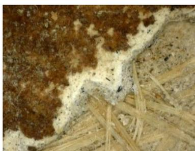
Figura 54. Detalle la diferenciación de primeras capas de preparación (gris), capas superiores de preparación (más claras), y película pictórica.
