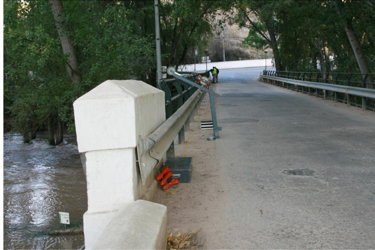
Figura 5 | Torno para descenso de turbisonda.
