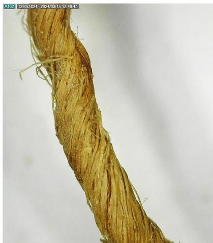
**Imagen 39.** Macrofotografía de un hilo, sentido de torsión Z. Realizada con Dinolite a 70X.
