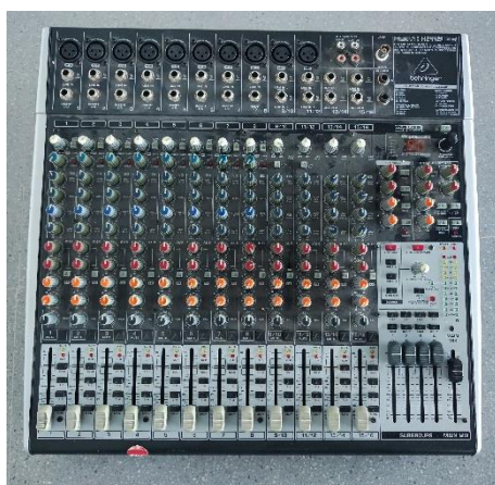
Fig. 18. Mixer QX2442USB de la marca Behringer. Utilizado en el proyecto instalativo final.
