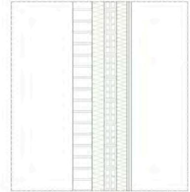
Una capa de ladrillo macizo, aislamiento, ladrillo hueco doble, una capa de aislamiento y placas de yeso laminado.
