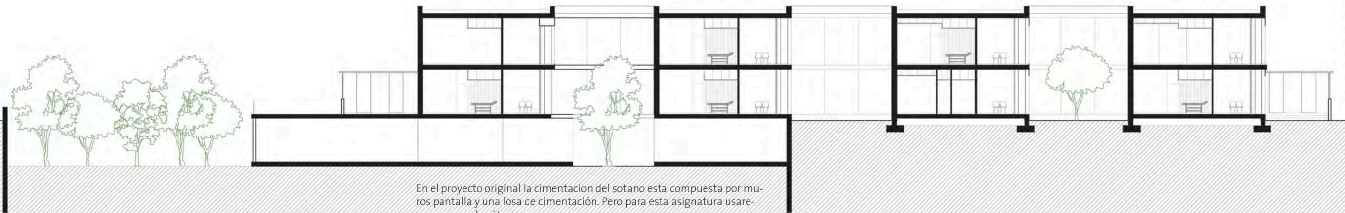
En el proyecto original la cimentación del sótano esta compuesta por muros pantalla y una losa de cimentación. Pero para esta asignatura usaremos muros de sótano.
