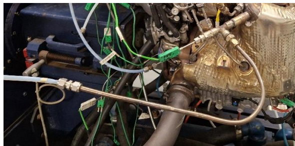
Figura 4.4. Sensor piezoeléctrico instalado en el motor ensayado
