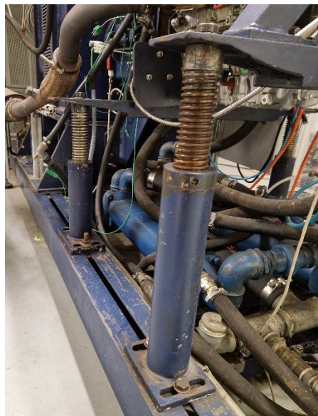
Figura 4.9. Estructura soporte del banco de pruebas
