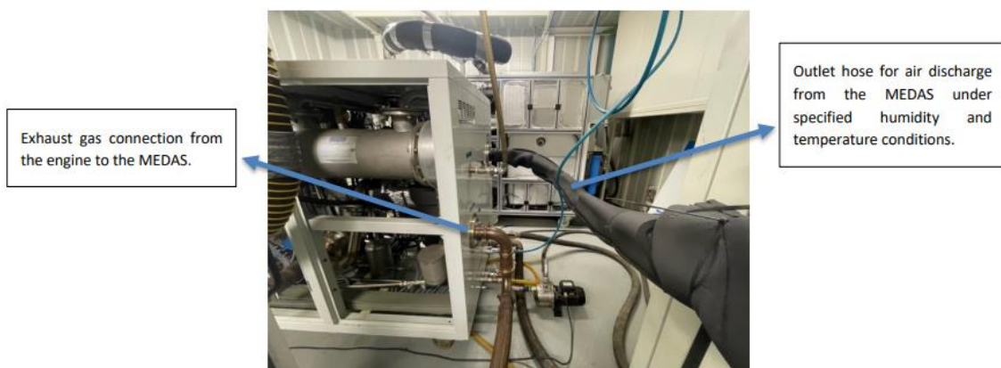
Figura 4.13. Acoplamiento de entrada y salida del MEDAS
