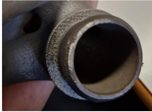
Figura 5.42. Conducto de alimentación del aire de EGR del compresor
