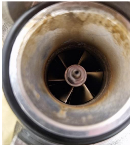
Figura 5.43. Condensación en la entrada de la carcasa del compresor
