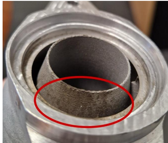
Figura 5.40. Condensación en el conducto de alimentación del compresor (2)
