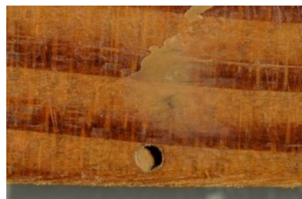
Fotografía 45: Macrofotografía de estuco utilizado en galería realizada por el ataque del agente xilófago.
