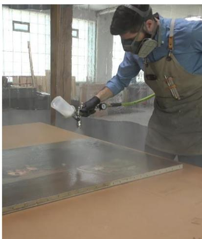
Fig 70. Aplicación de barniz mediante compresor.
