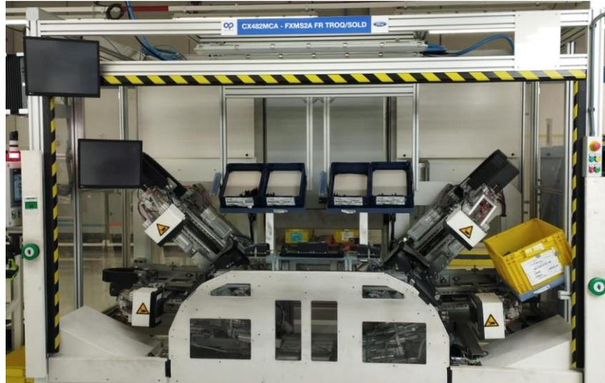
Ilustración 2.18 Máquina FXMS2A montaje paragolpes Front Kuga (Fuente: Plastic Omnium)
