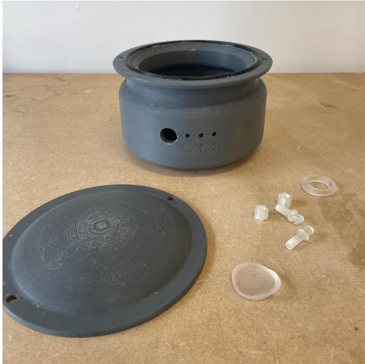
*Figura 94: Todas las piezas del prototipo de la carcasa del dispositivo GA-02.*
