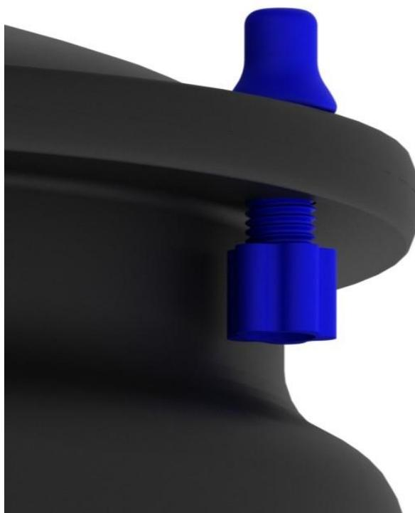
*Figura 103: Render de detalle del juego de tornillo y tuerca.*
