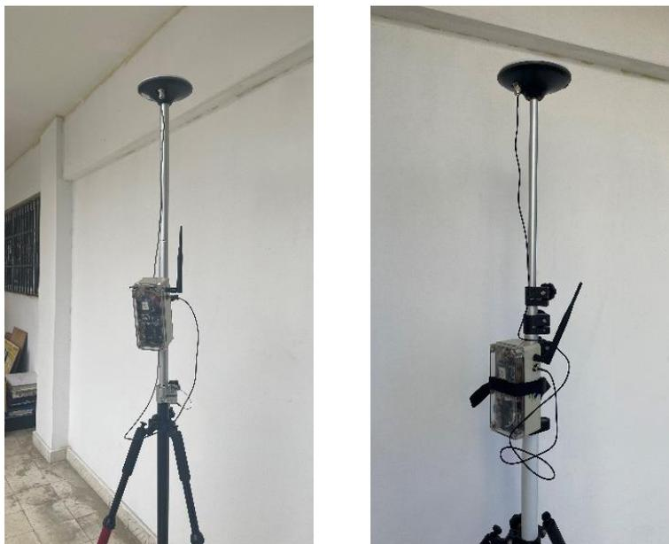
Figura 52a, 52b: Dispositivo del rover y dispositivo de la base ya ensamblados.
