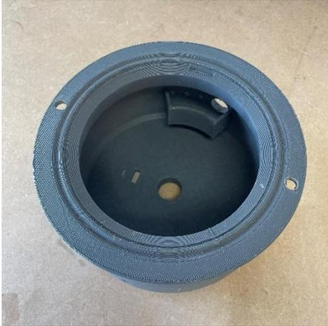
*Figura 36: Interior del recipiente inferior impreso en 3D de la carcasa.*
