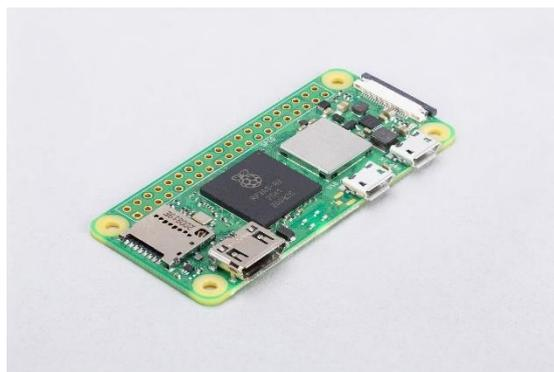
Figura 26: Placa Raspberry Pi Zero 2 W (RaspberryPi.dk, s. f.).
