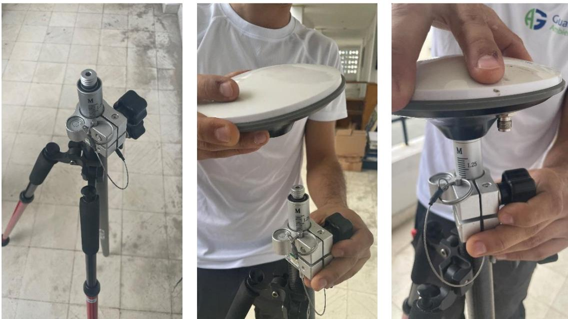
Figura 44a, 44b, 44c: Jalón del rover y colocación de la antena sobre este.
