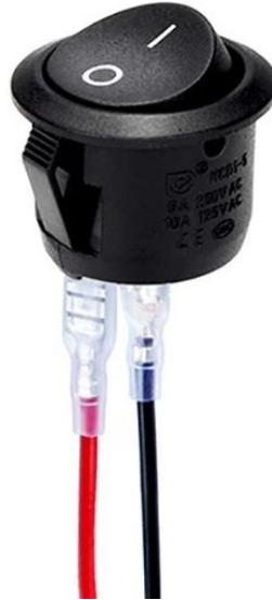
Figura 13: Interruptor redondo basculante (Autozoco, s.f.).
