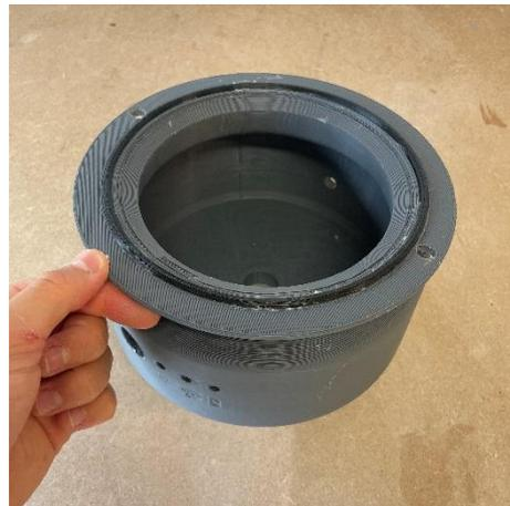
*Figura 38a, 38b: Colocación de la goma superior sobre el recipiente inferior.*
