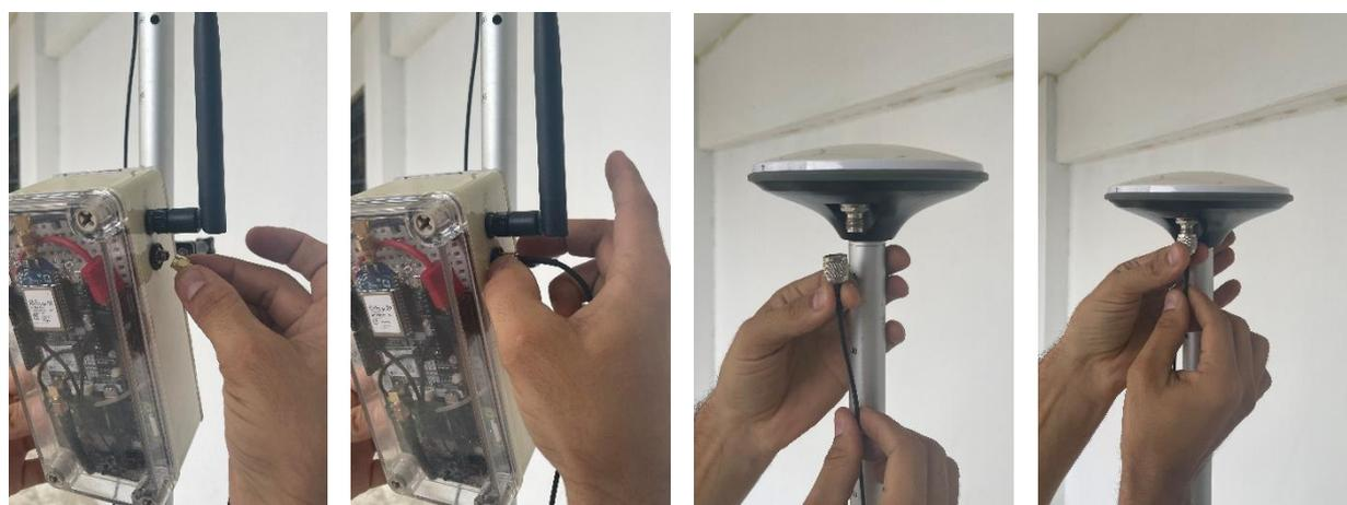
*Figura 50a, 50b, 50c, 50d: Ensamblaje del cable de comunicación de la antena superior.*
