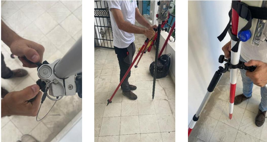
*Figura 51a, 51b, 51c: Ajuste de los jalones pequeños sobre el plano del suelo del rover y la base.*
