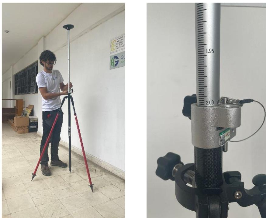
Figura 45a, 45b: Ajuste del jalón y medidor numérico del costado del jalón central.
