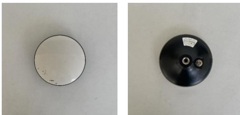
Figura 19a, 19b: Antena GNSS del dispositivo GA-01.
