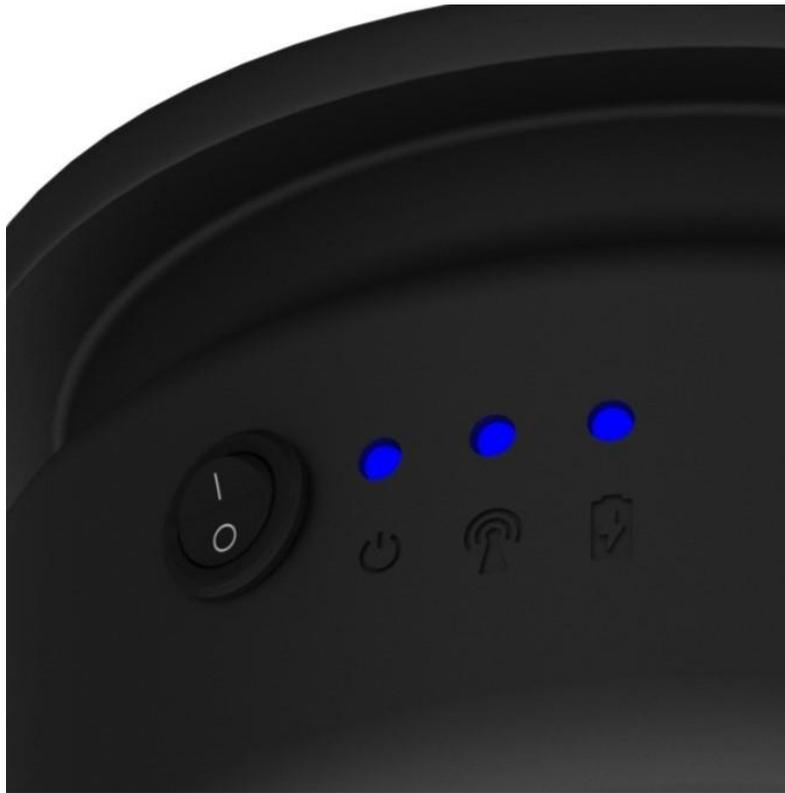
*Figura 104: Render de detalle de los ledes de notificación y el interruptor.*
