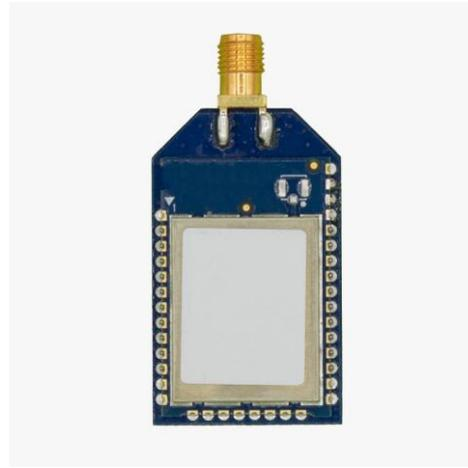
Figura 6a, 6b: Módulo de radio de largo alcance LR y XLR que usa el GA-01 y sus dimensiones (ArduSimple, s. f.).
