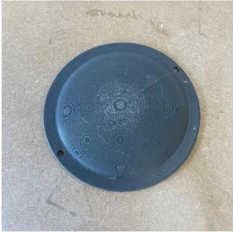
*Figura 34: Impresión en 3D de la tapa de la carcasa.*
