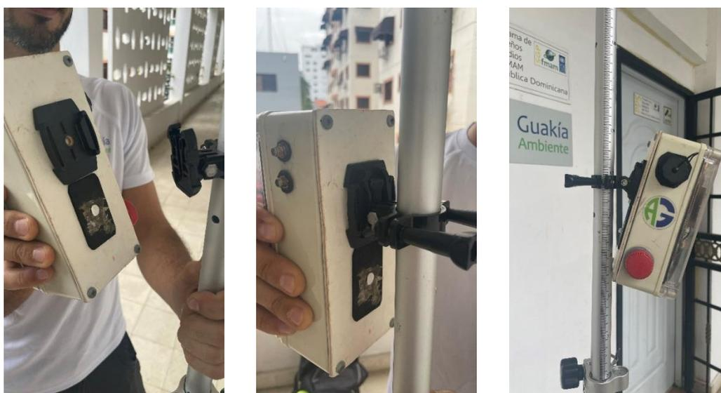
Figura 48a, 48b, 48c: Ajuste de la carcasa del rover sobre el aplique de cámara deportiva.
