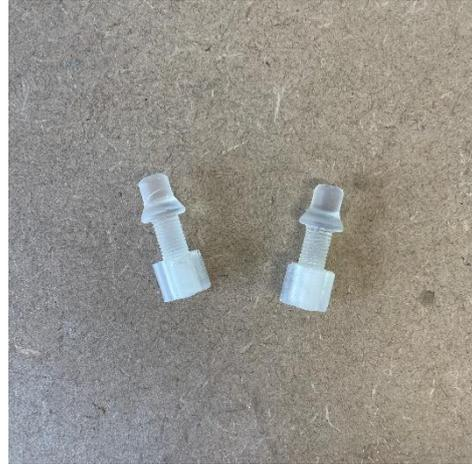
*Figura 35: Juego de tornillos y tuercas impresos en 3D de la carcasa.*
