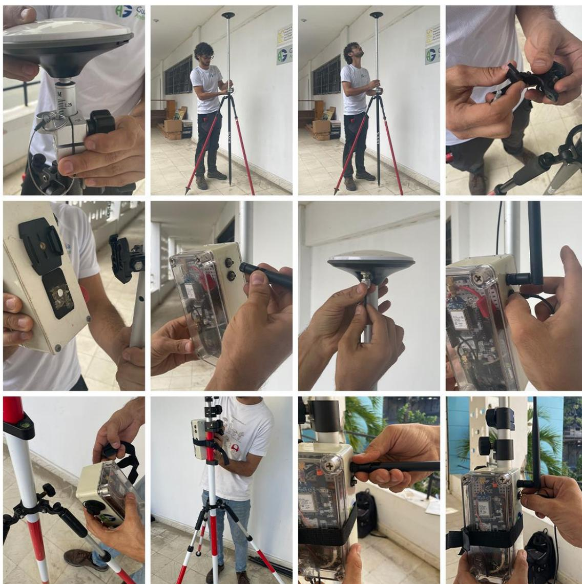
Figura 57: Fotomontaje del manejo del dispositivo GA-01.
