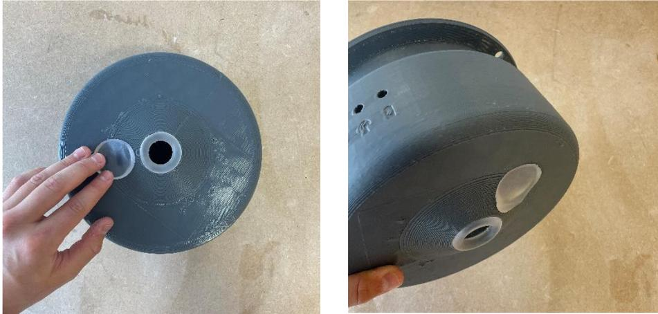
*Figura 39a, 39b: Colocación del tapón y la goma inferior en el recipiente inferior.*
