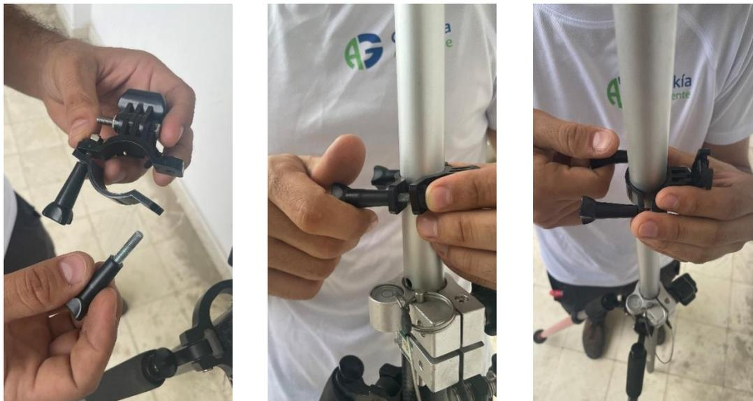
Figura 47a, 47b, 47c: Ajuste del aplique de la cámara deportiva al jalón central.
