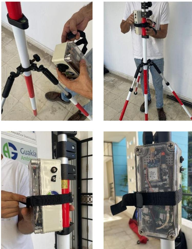
*Figura 46a, 46b, 46c, 46d: Ajuste de la cinta y la carcasa sobre el jalón.*
