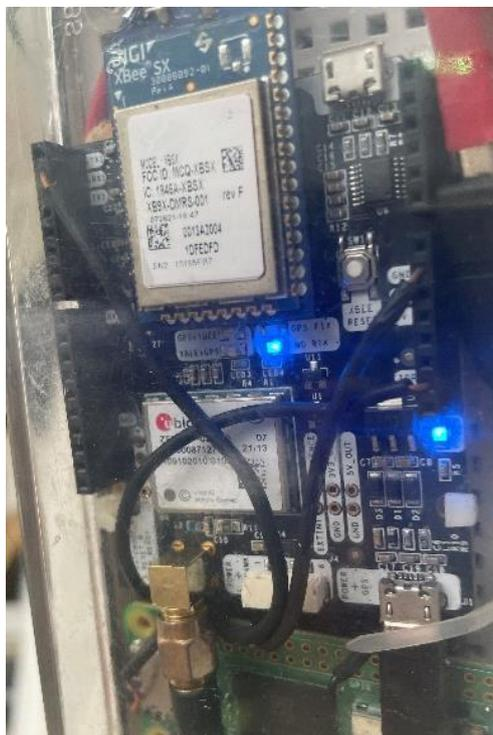
*Figura 54: Ledes encendidos de la placa rtk2base del rover.*
