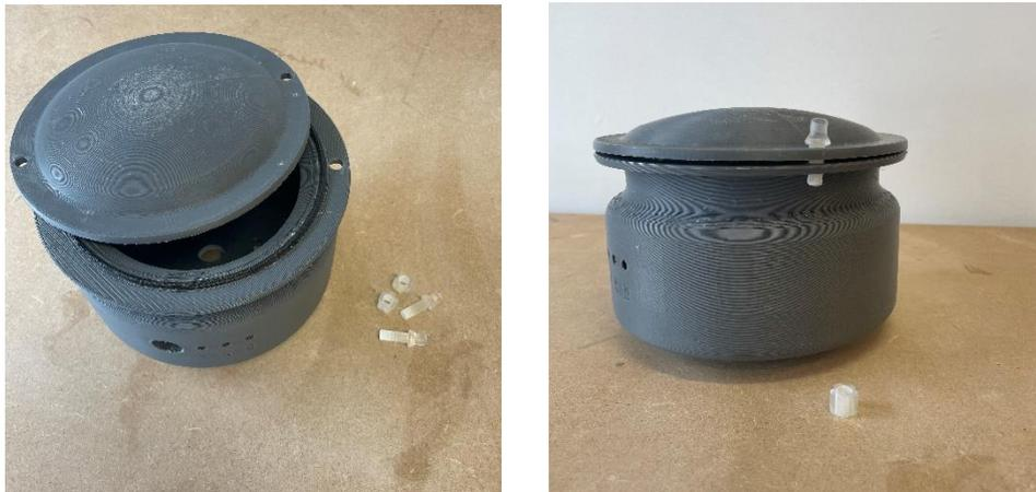
*Figura 40a, 40b: Colocación de los tornillos y tuercas para ajustar la tapa sobre el recipiente.*
