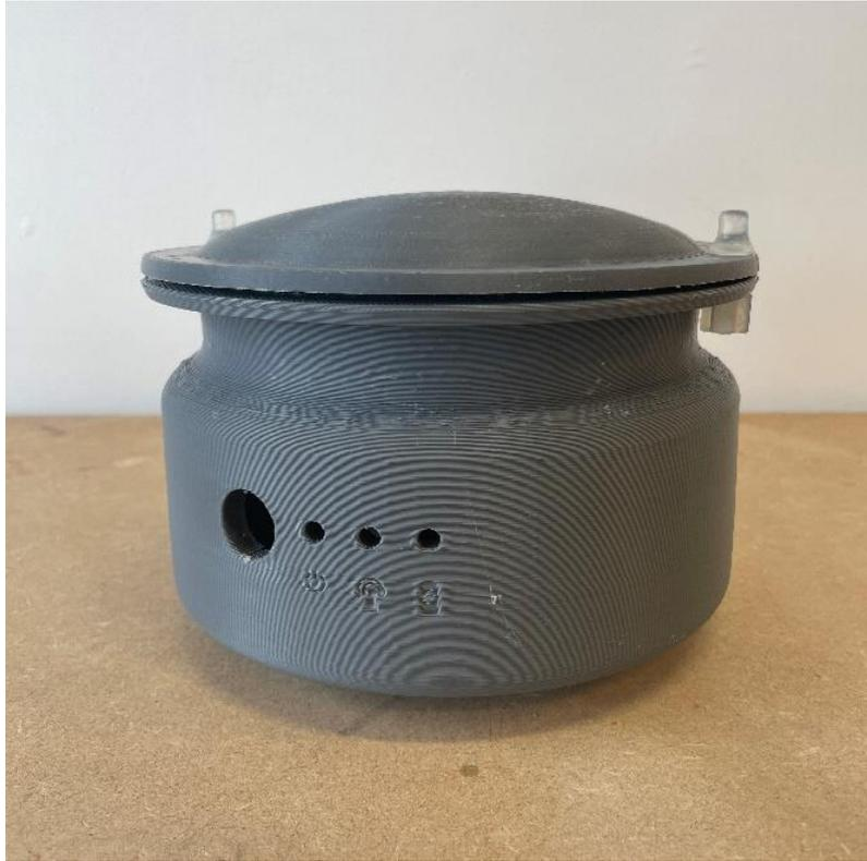
*Figura 96: Prototipo montado de la carcasa del dispositivo GA-02.*
