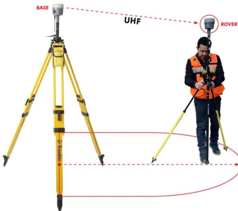
Figura 7: Persona usando un dispositivo con sistema RTK, usando como vínculo de comunicación tecnología de radiofrecuencias (GEOCOM, 2023).
