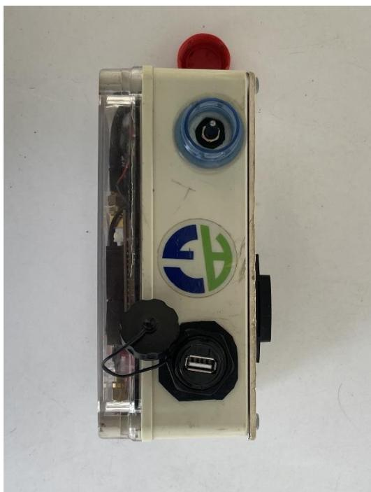
Figura 34: Interruptor del dispositivo GA-01.
