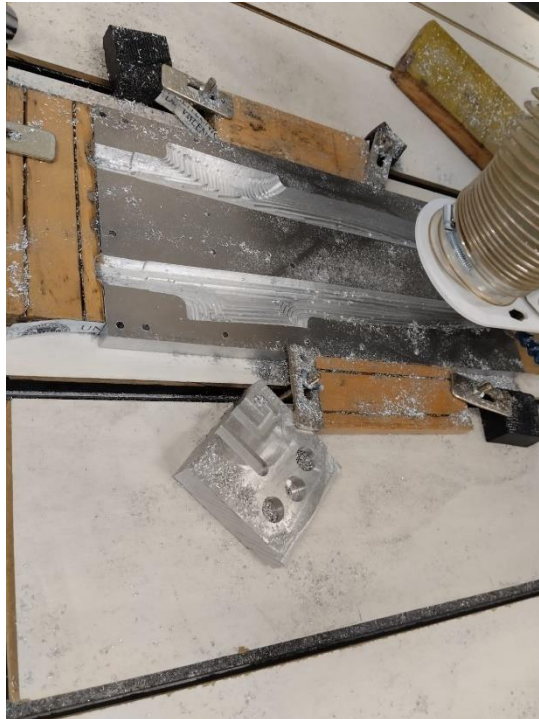
Ilustración 59. Mecanizado del molde del fuselaje. La máquina se encuentra realizando la operación de acabado.
