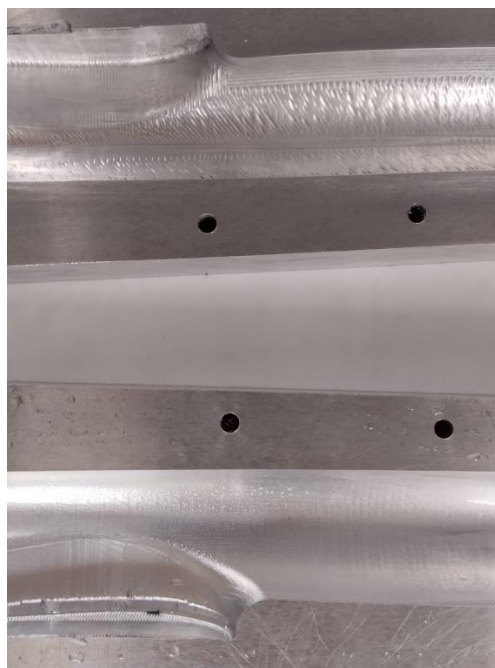
Ilustración 60. Comparativa del acabado rugoso (arriba) y pulido (abajo).
