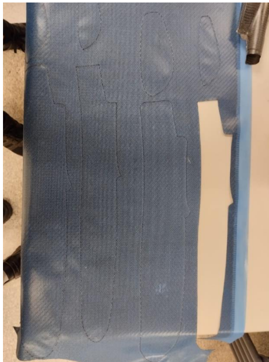
Ilustración 61. Hoja de preimpregnado de fibra de carbono con los cortes para la fabricación de las distintas partes.
