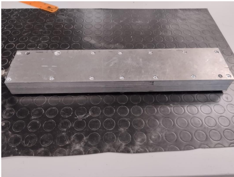
Ilustración 64. Cierre del par de moldes del fuselaje.
