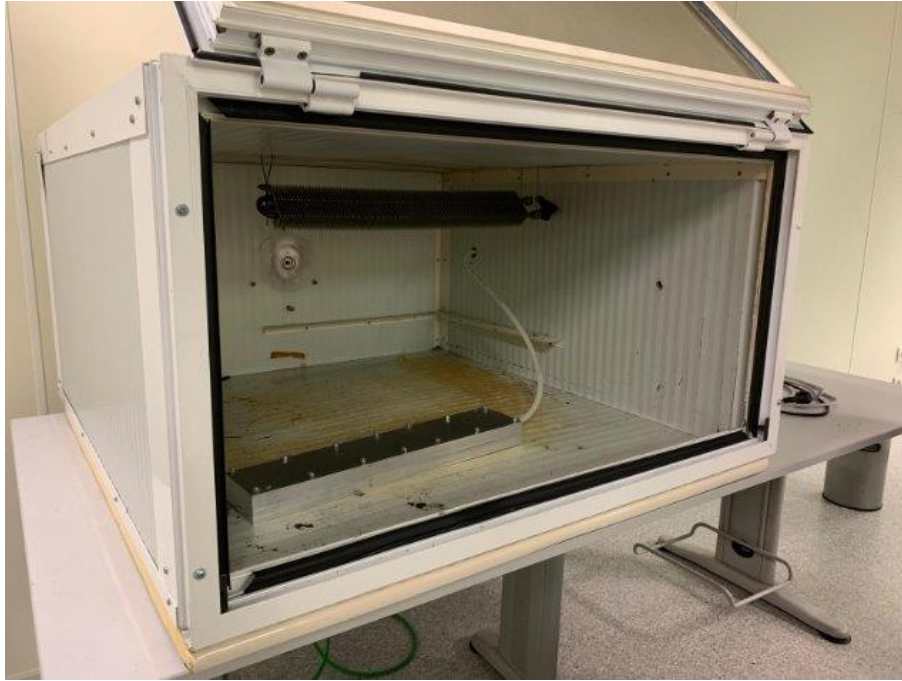
Ilustración 65. Molde dentro del horno de curado.
