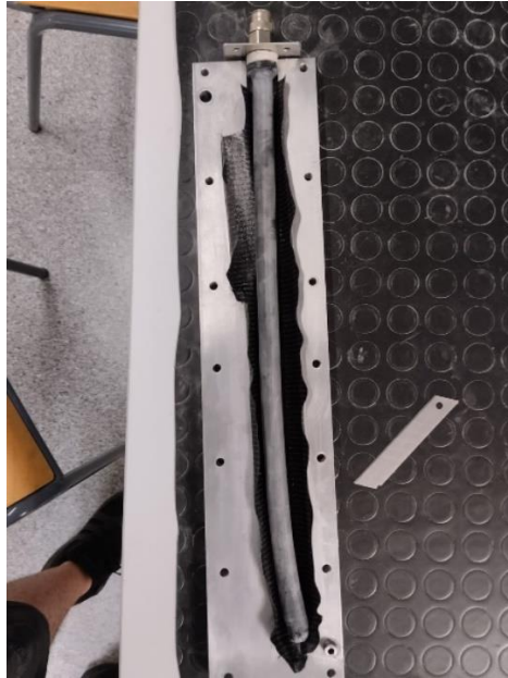
Ilustración 63. Tubo hinchable que se introduce en el molde de forma que ejerza presión sobre las paredes para obtener el mejor resultado posible.
