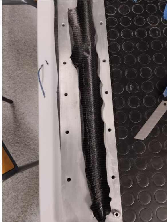
Ilustración 62. Colocación de la fibra de carbono sobre el molde.
