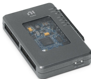
Figura 16: Sistema de adquisición y control - MyRio 1900 [5]
