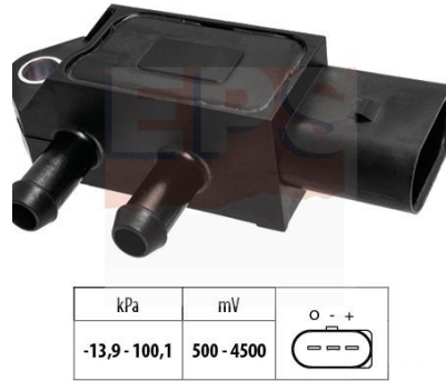
Figura 14: Sensor de presión diferencial 03L 906 051B [14]
