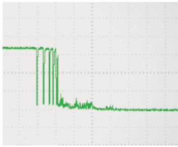
Figura 44: Señal a evitar aplicando el Anti-Bounce en la FPGA [17]
