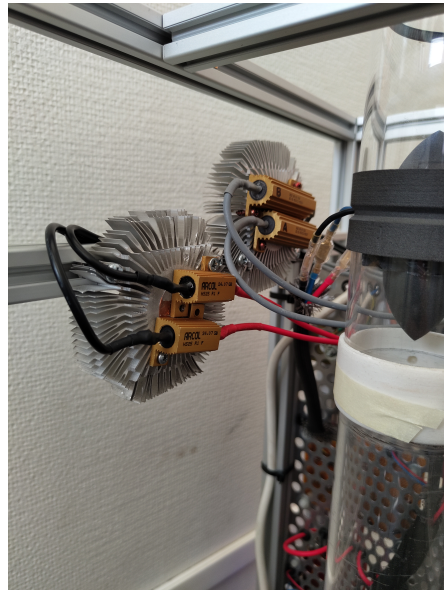
Figura 20: Montaje de las resistencias
