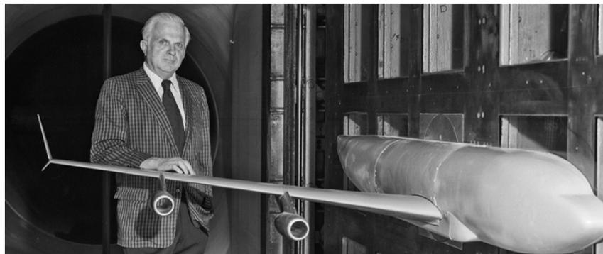
Figura 2.9: Ensayos en túnel de viento del winglet Whitcomb [8].
